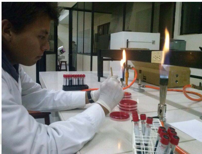
Foto N° 20: Siembra del Caldo Rappaport-Vassiliadis sobre Agar Xilosa Lisina Desoxicolato.
