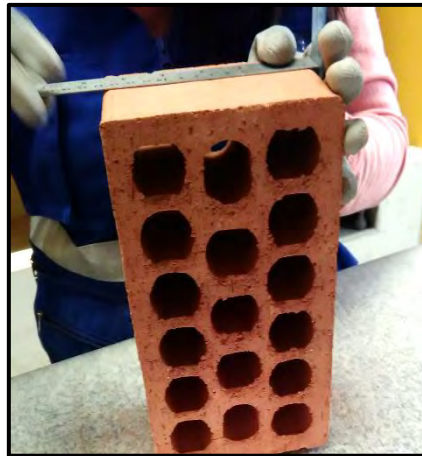
Figura 29: Medición del ancho - Ensayo de variación dimensional
