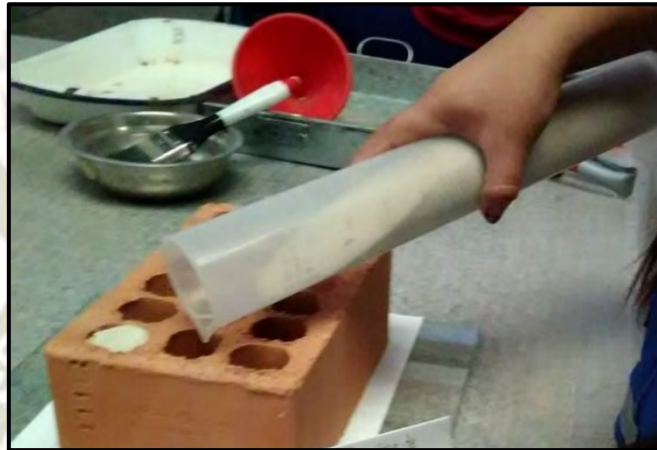
Figura 33: Llenado de perforaciones del ladrillo con arena graduada
