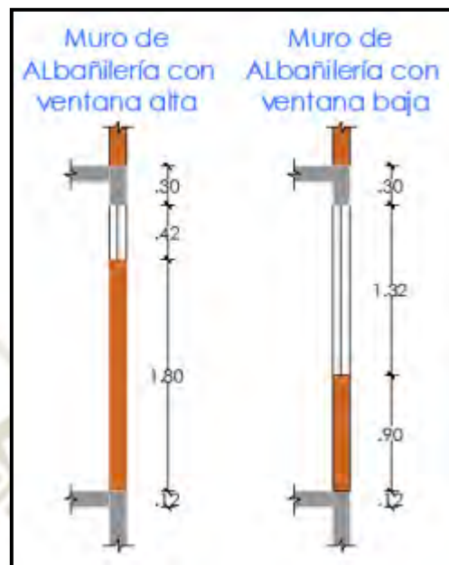
Figura 62: Detalle secciones verticales típicas
