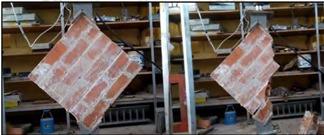
Figura 53: Murete sin refuerzo antes y después de ensayo de compresión diagonal
