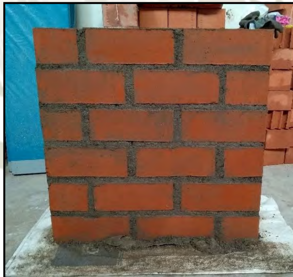
Figura 55: Asentado de muro de albañilería
