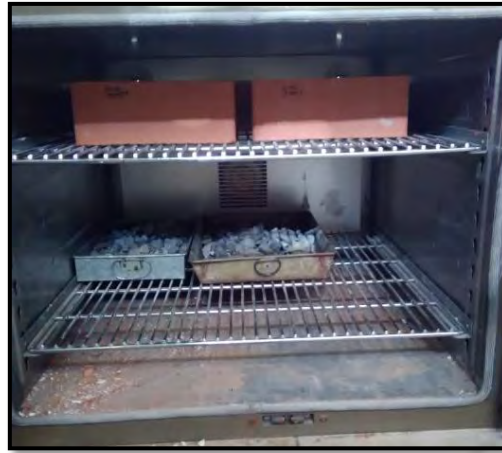
Figura 35: Secado de las unidades de albañilería King Kong H-9
