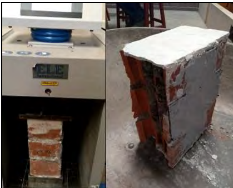
Figura 49: Pilas antes y después de ensayo de compresión axial
