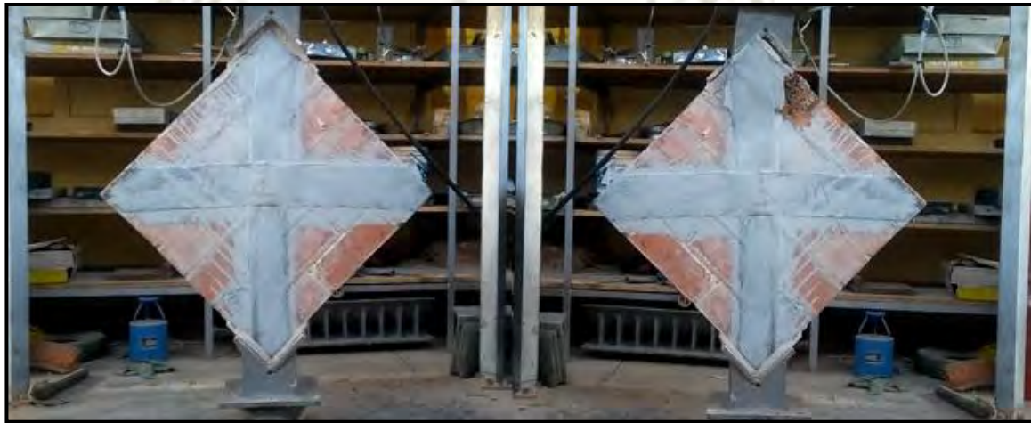
Figura 57: Murete con refuerzo de fibra de carbono antes y después de ensayo de compresión diagonal
