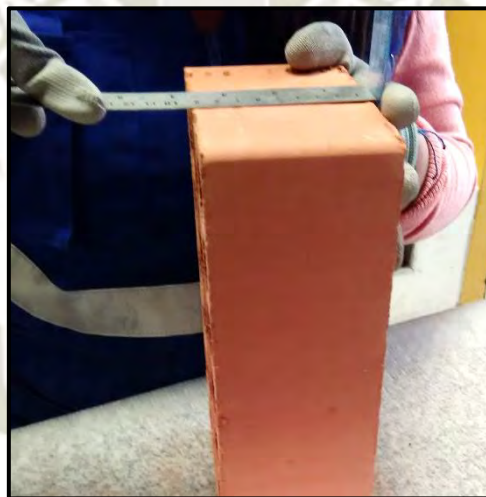
Figura 30: Medición de la altura - Ensayo de variación dimensional
