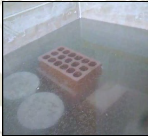
Figura 36: Unidades de albañilería King Kong H-9 completamente sumergida
