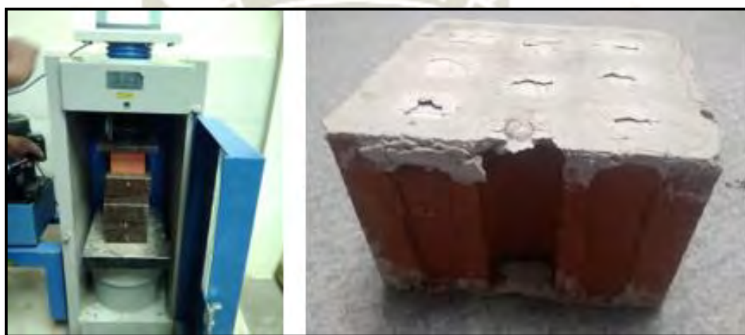
Figura 32: Ensayo de resistencia a la compresión axial de la unidad de albañilería King Kong H-9
