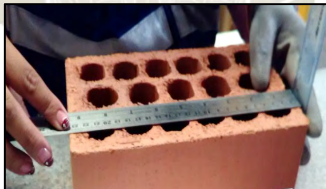
Figura 28: Medición del largo - Ensayo de variación dimensional
