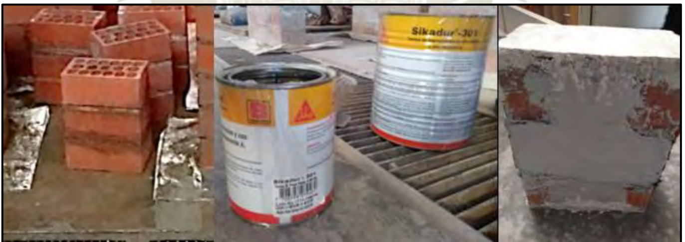
Figura 48: Asentado y colocación de pila con refuerzo de fibra de carbono
