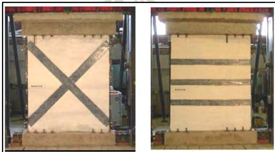
Figura 26: Muros reforzados con CFRP
