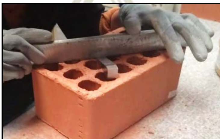
Figura 31: Ensayo de alabeo
