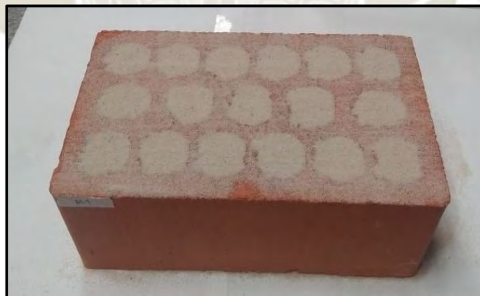
Figura 34: Ladrillo lleno de arena graduada
