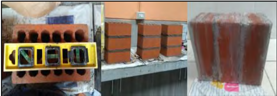
Figura 45: Asentado y colocación de capping en las pilas
