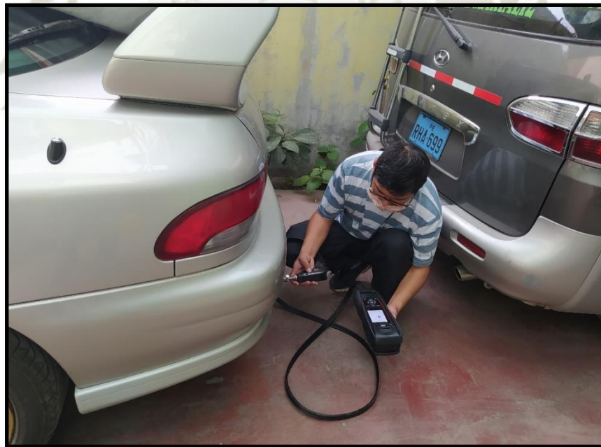
Figura 35 Medición de gases de combustión
