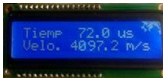
Figura 4.5 Tiempo y velocidad mostrados en el LCD.
