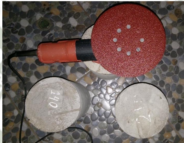
Figura 4.2 Probetas pulidas para mejorar el acoplamiento mecánico
