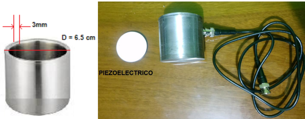
Figura 3.19 Construcción del palpador.
