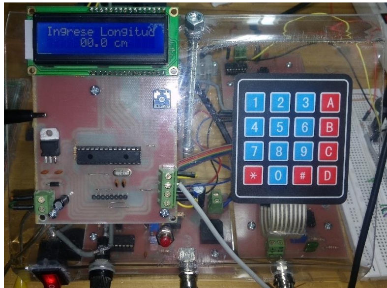
Figura 4.3 Prototipo de ultrasonido en funcionamiento.
