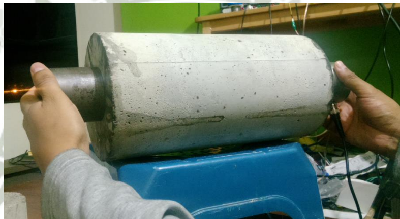
Figura 4.4 Palpadores en posición.
