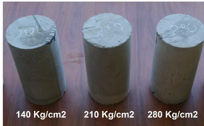
Figura 4.1 Probetas con FC de 140, 210, 280 Kg/cm 2
