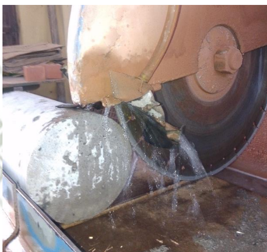
Figura 4.8 Corte de nivelación con disco diamantado
