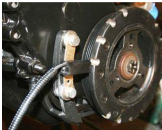
Figura 35. Ubicación del sensor CKP. Tomado de “Auto Avance”. Recuperado de https://www.autoavance.co/blog-tecnico-automotriz/149-que-es-un-sensor-de-posicion-del-ciguenal-sensor-ckp-y-cmp/
