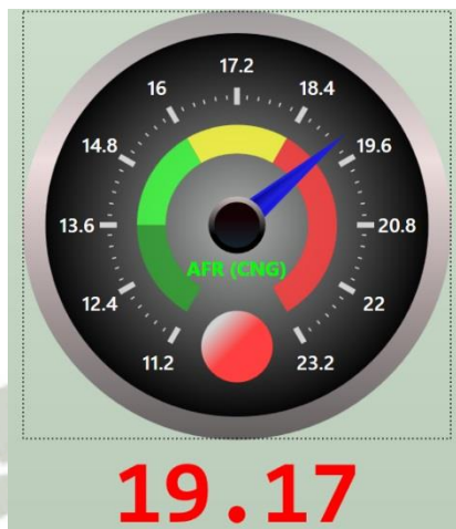
Figura 80. Valor del sensor Lambda para 3.3 milisegundos de tiempo de inyección. Fuente: Elaboración propia.
