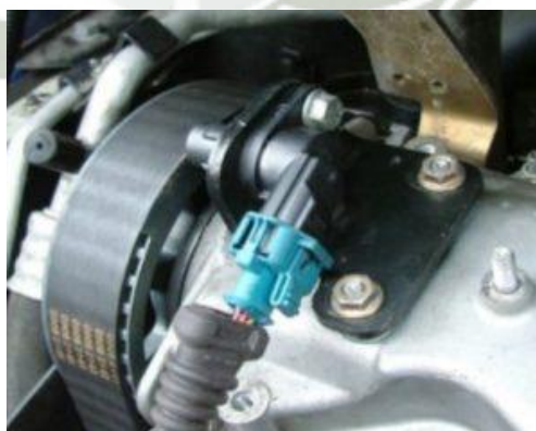
Figura 36. Ubicación del sensor CPM Tomado de “Auto Avance”. Recuperado de https://www.autoavance.co/blog-tecnico-automotriz/149-que-es-un-sensor-de-posicion-del-ciguenal-sensor-ckp-y-cmp/
