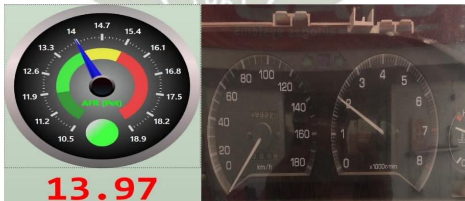
Figura 77. Mezcla estequiometria a 2000 RPM. Fuente elaboración propia.
