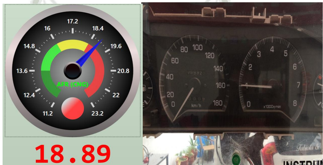
Figura 82. Mezcla estequiometria a 1000 RPM. Fuente: Elaboración propia.
