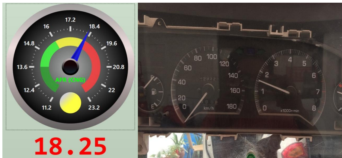
Figura 83. Mezcla estequiometria a 1500 RPM. Fuente: Elaboración propia.
