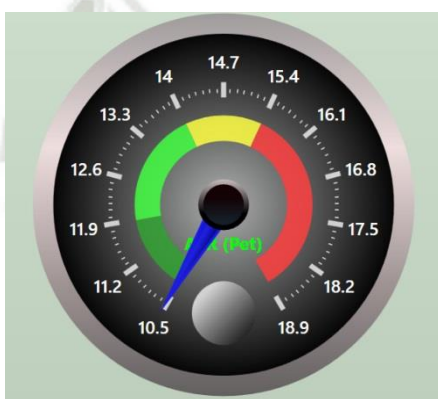
Figura 43. Mezcla estequiometría gasolina. . Fuente: Elaboración propia.
