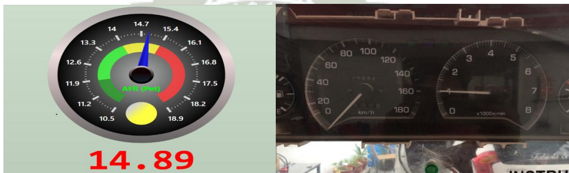
Figura 75. Mezcla estequiometría a 1000 RPM. Fuente: Elaboración propia.
