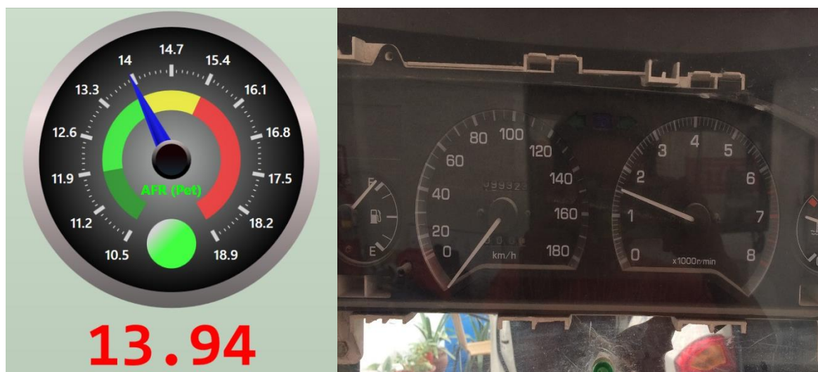
Figura 76. Mezcla estequiometria a 1500 RPM. Fuente: Elaboración propia.
