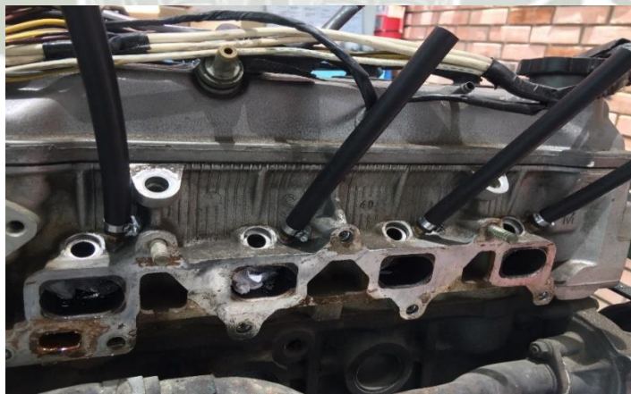
Figura 11. Perforación para la ubicación de inyectores de gas. . Fuente: Elaboración propia.
