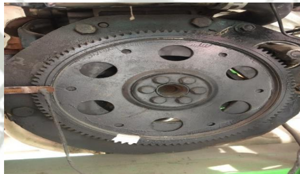
Figura 37. Eje de cigüeñal marcado para la puesta a punto. Fuente: Elaboración propia.
