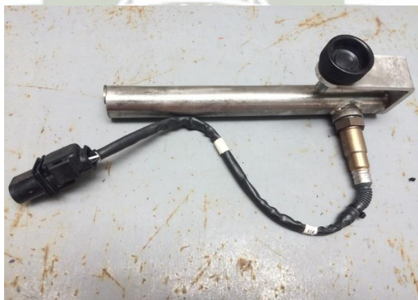
Figura 42. Sensor de medida Kit AFR. . Fuente: Elaboración propia.
