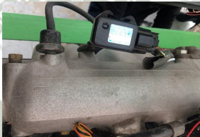
Figura 39. Ubicación del sensor MAP. Fuente: Elaboración
