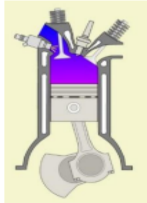
Figura 4. Etapa de admisión ciclo Otto. Tomado de “Instrumentación y control para la conversión de un motor de combustión interna a bi-combustible, por Abraham Sánchez Martínez 2014, p. 18.
