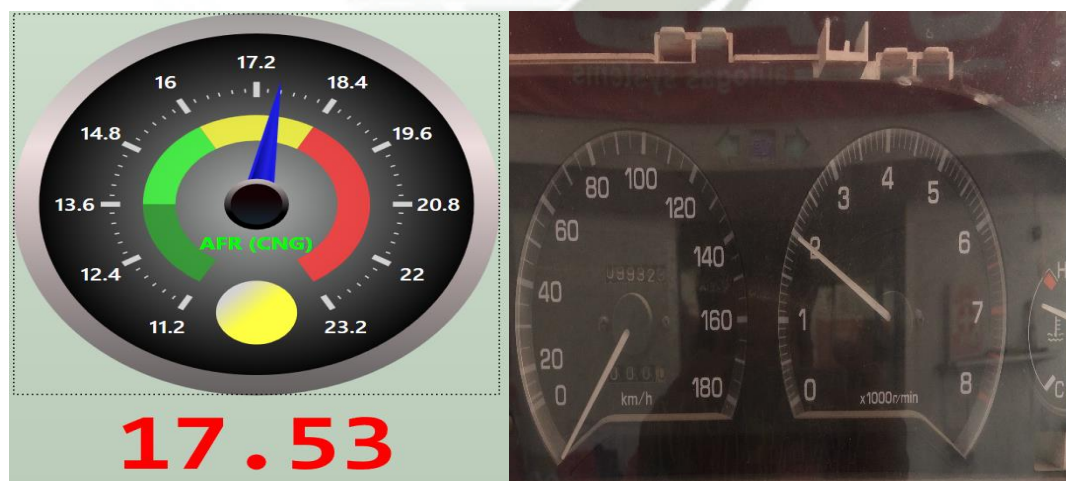
Figura 84. Mezcla estequiometria a 2000 RPM. Fuente: Elaboración propia.
