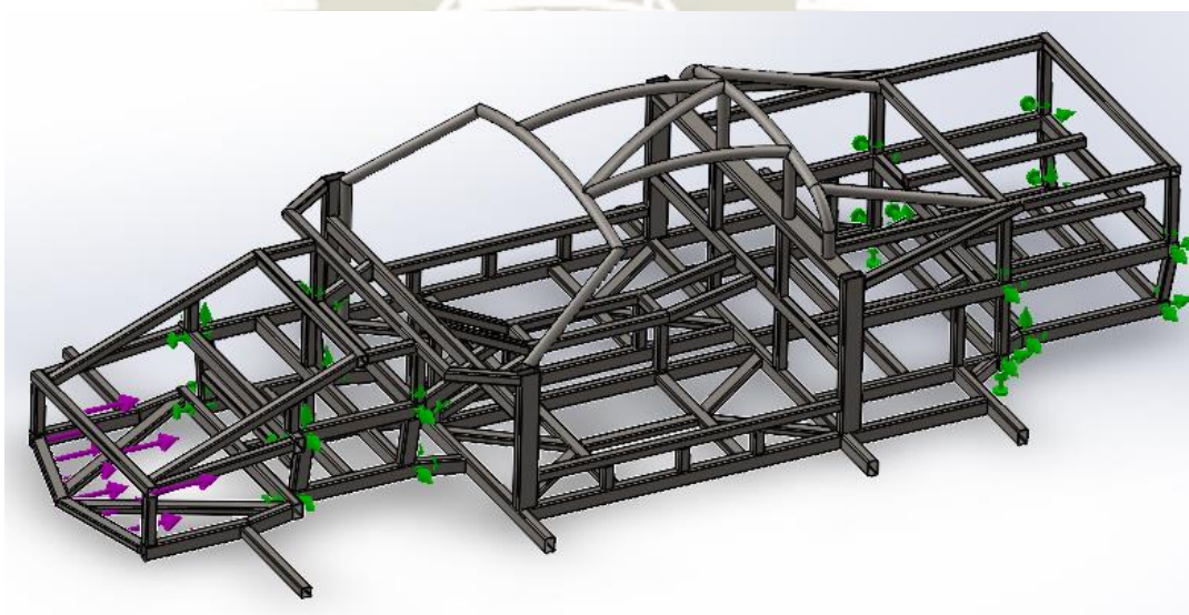
Figura 4.87 Distribución de fuerzas por carga frontal Fuente: Elaboración propia
