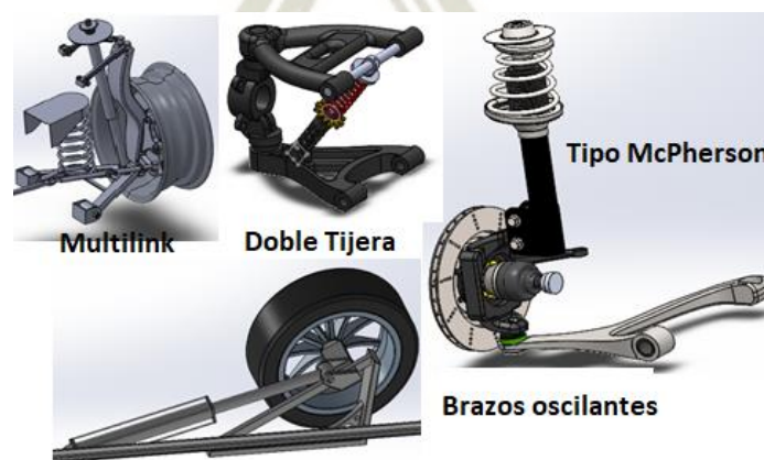
Figura 2.15 Tipos de suspensión vehicular más comunes Fuente: Elaboración propia
