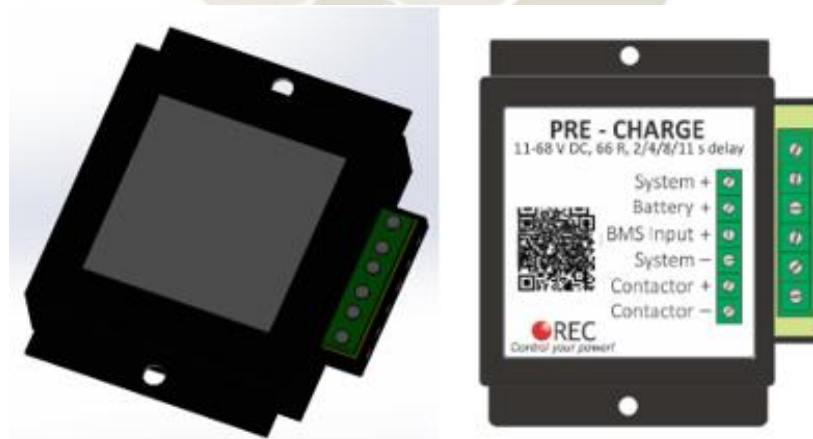
Figura 4.35 Unidad de precarga modelo Rec y diseño 3d Fuente: Elaboración propia
