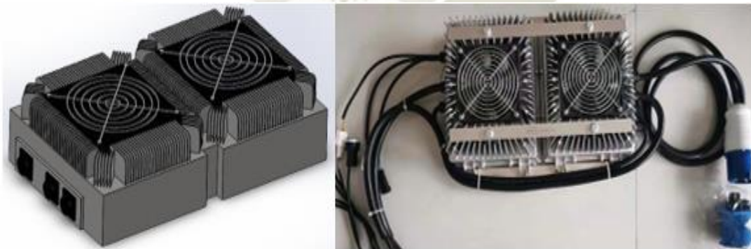
Figura 4.42 Cargador de baterías Longrun-Q2 y su modelo 3d Fuente: Elaboración propia
