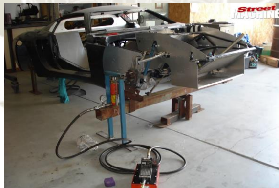
Figura 2.23 Ensayo de rigidez torsional de un chasis Fuente: Bartrop (2020)
