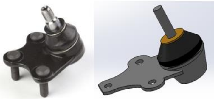
Figura 4.114 Rotula de suspensión delantera y diseño 3d Fuente: Elaboración propia
