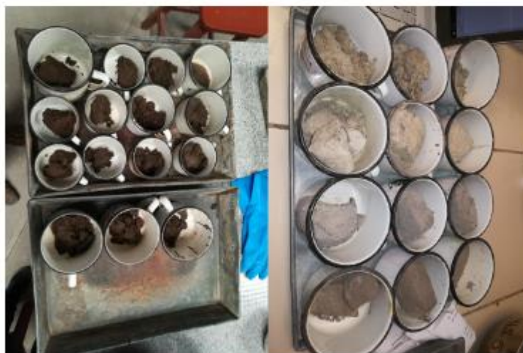
Foto 18 Ensayo de humedad en estado natural Fuente: Toma propia
