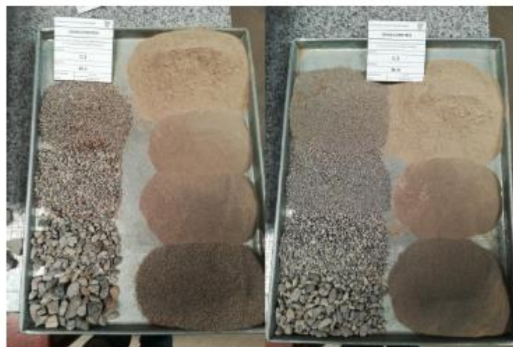
Foto 10 Granulometría calicata 02-Muestras del estrato 3 y 4. Fuente: Toma propia
