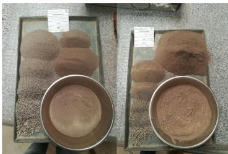
Foto 12 Granulometría calicata 03-Muestras del estrato 5 y 6. Fuente: Toma propia
