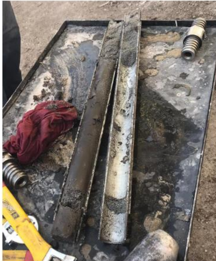
Foto 24: Muestras inalteradas obtenidas con el ensayo SPT Fuente: Toma propia
