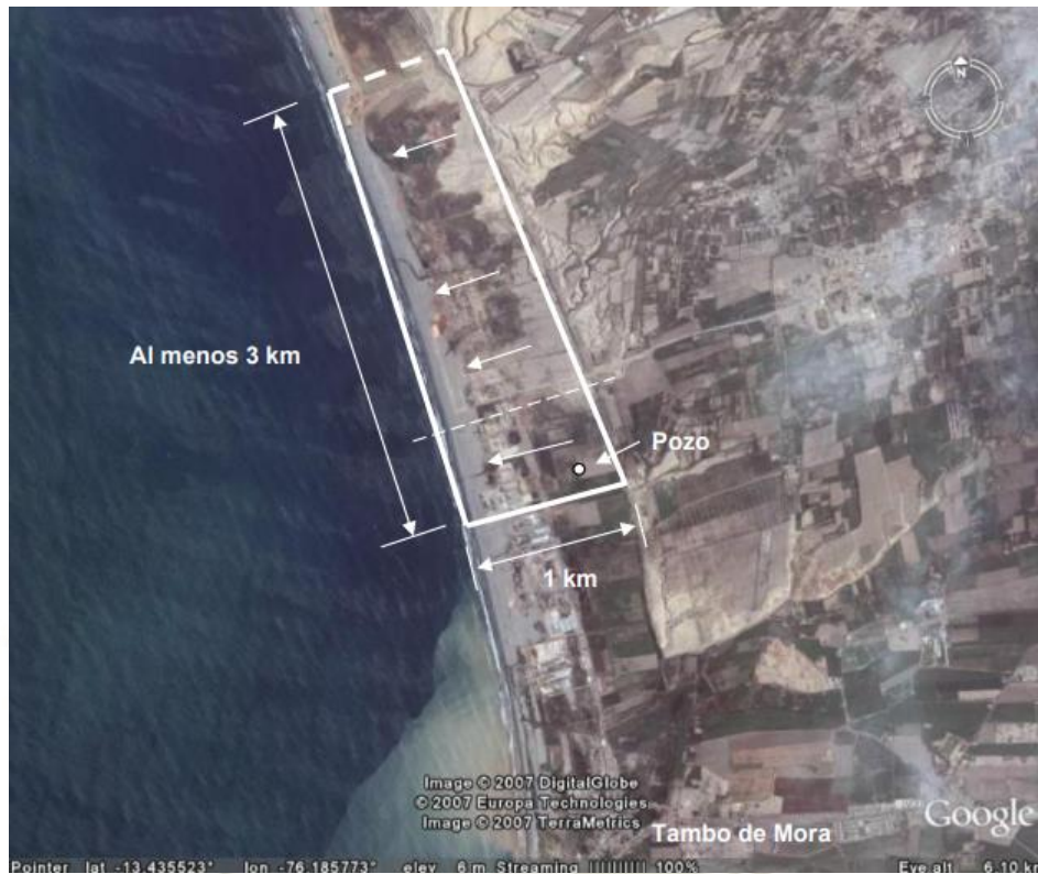
Ilustración 39: Desplazamiento lateral del terreno asociado a la licuación en Canchamaná. Fuente: Google Earth
