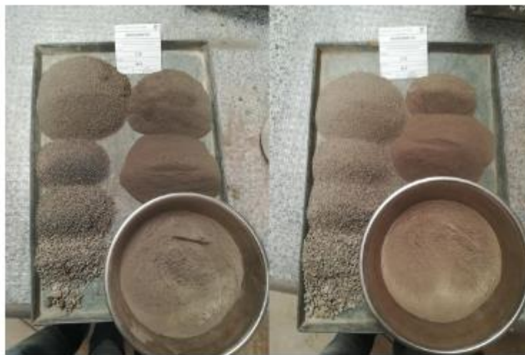
Foto 11 Granulometría calicata 03-Muestras del estrato 3 y 4. Fuente: Toma propia
