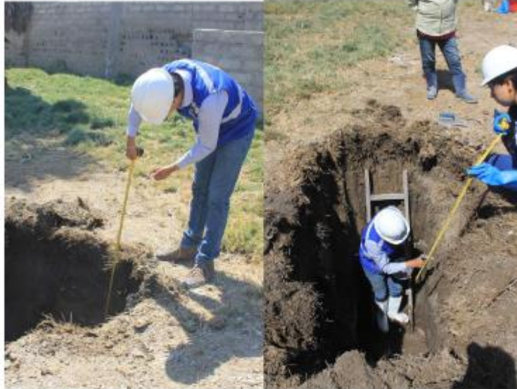
Foto 3 Calicata 3 en el C. P. El Pasto. Fuente: Toma propia.
