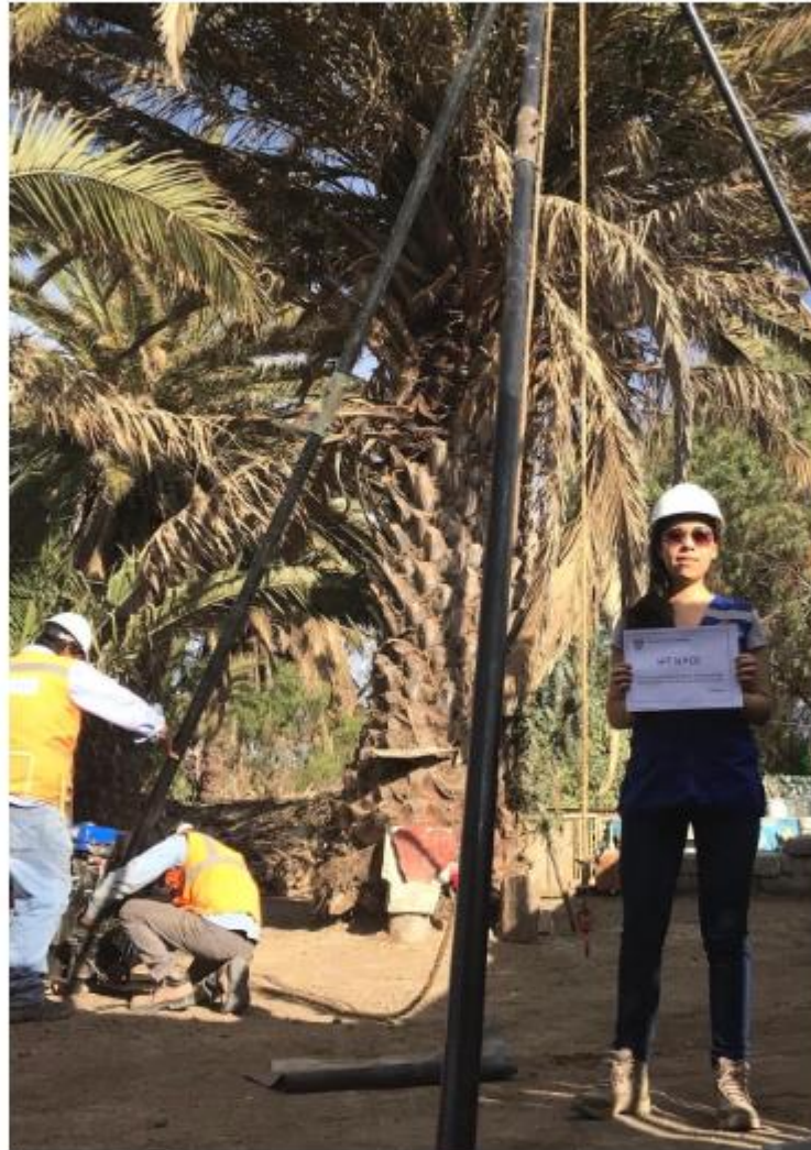
Foto 22: Ensayo de Penetración Estándar N°02 Fuente: Toma propia
