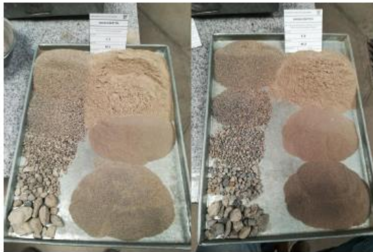
Foto 9 Granulometría calicata 02-Muestras del estrato 1 y 2. Fuente: Toma propia
