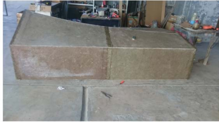
FOTO 2 Fabricación de la Caja del Lisímetro
