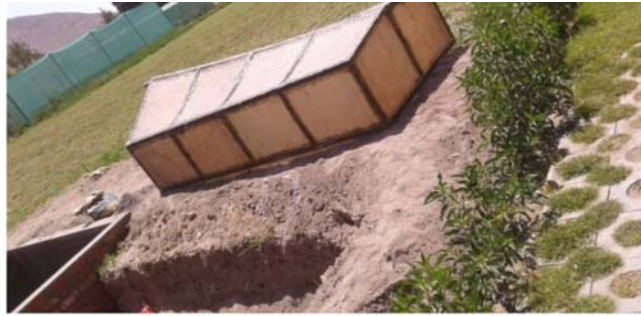
FOTO 3 Caja del Lisímetro con Estructura Metálica en Forma de Jaula
