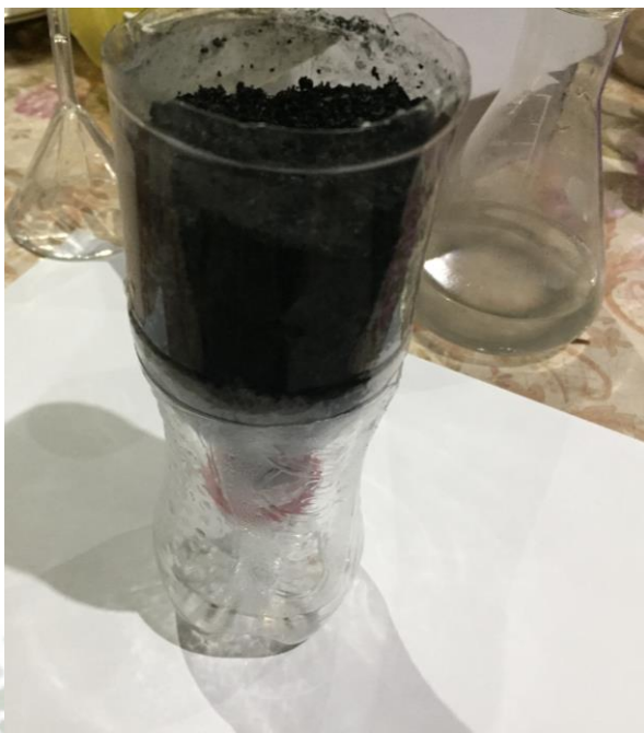
Figura N°6: Filtro Experimental de Carbón Activado
