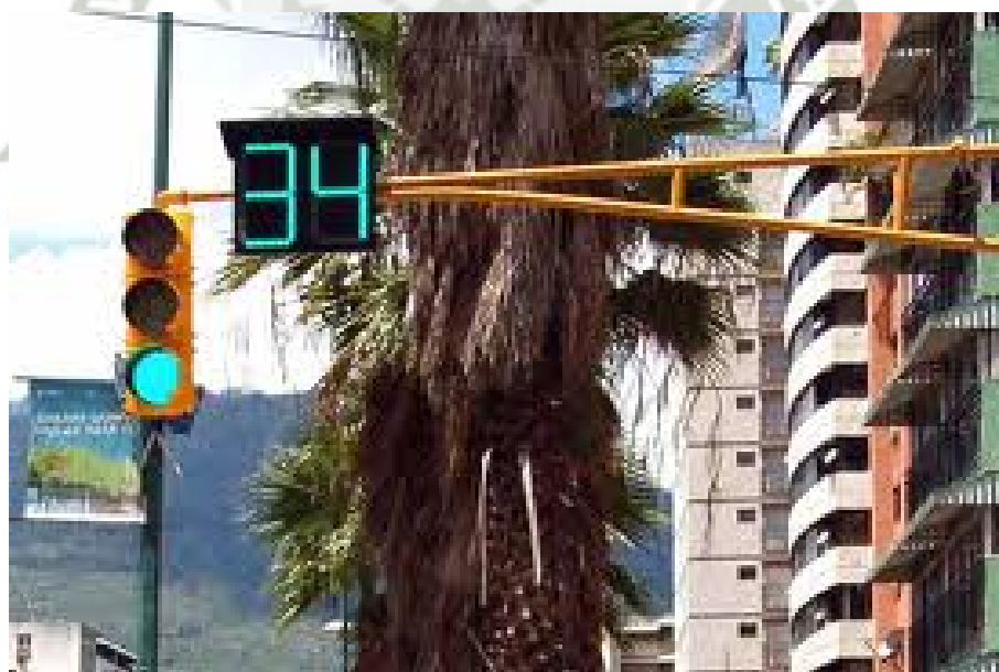
FIGURA 55. SEMÁFOROS CON CONTADOR CON LOS QUE EXISTEN EN NUESTRO PAÍS. PERO NO SON AUTOMATIZADOS FUENTE: ARCHIVO.LOSANDES.COM.AR
