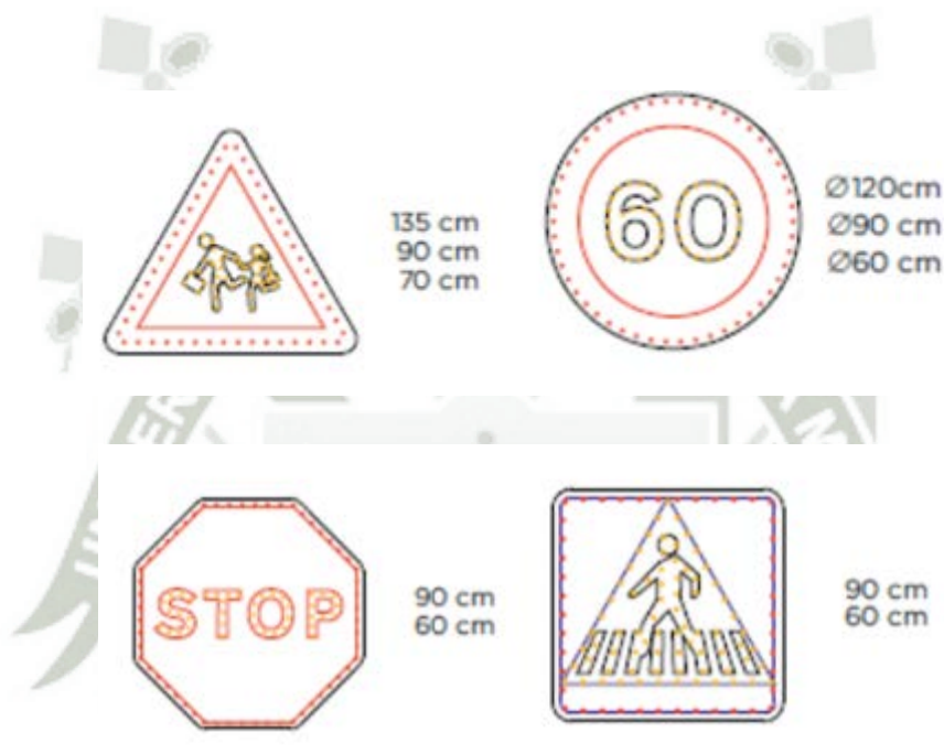
FIGURA 114. DIMENSIONES DE LA SEÑALIZACIÓN ELECTRÓNICA FUENTE: WWW.GOOGLE.COM
