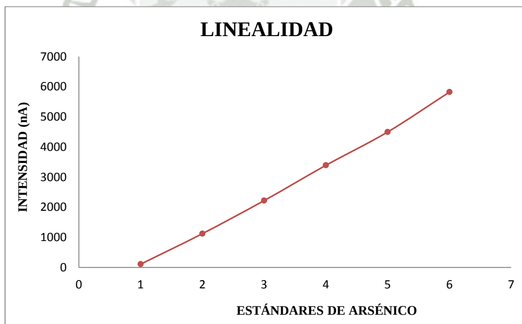
FIGURA 3. Representación gráfica de la linealidad del método para la determinación de arsénico.
