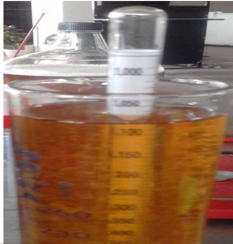
Figura 19. Muestra extraída previamente enfriada aproximadamente 100mL en una probeta, se procede a la medición de densidad inicial.
