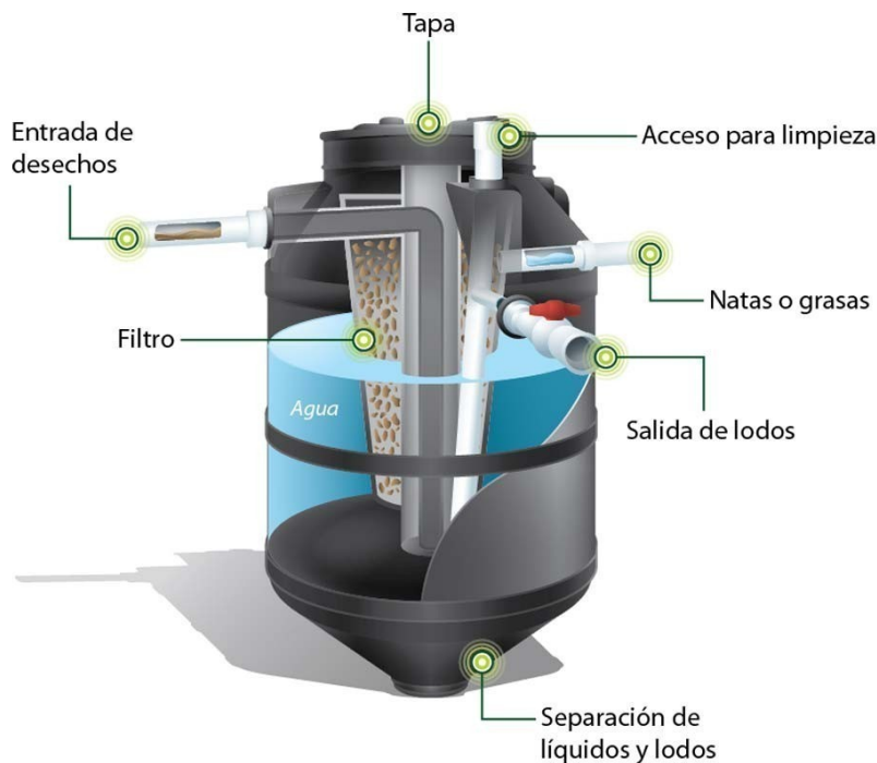
Imagen 178; Esquema de Biodigestor Autolimpiable
