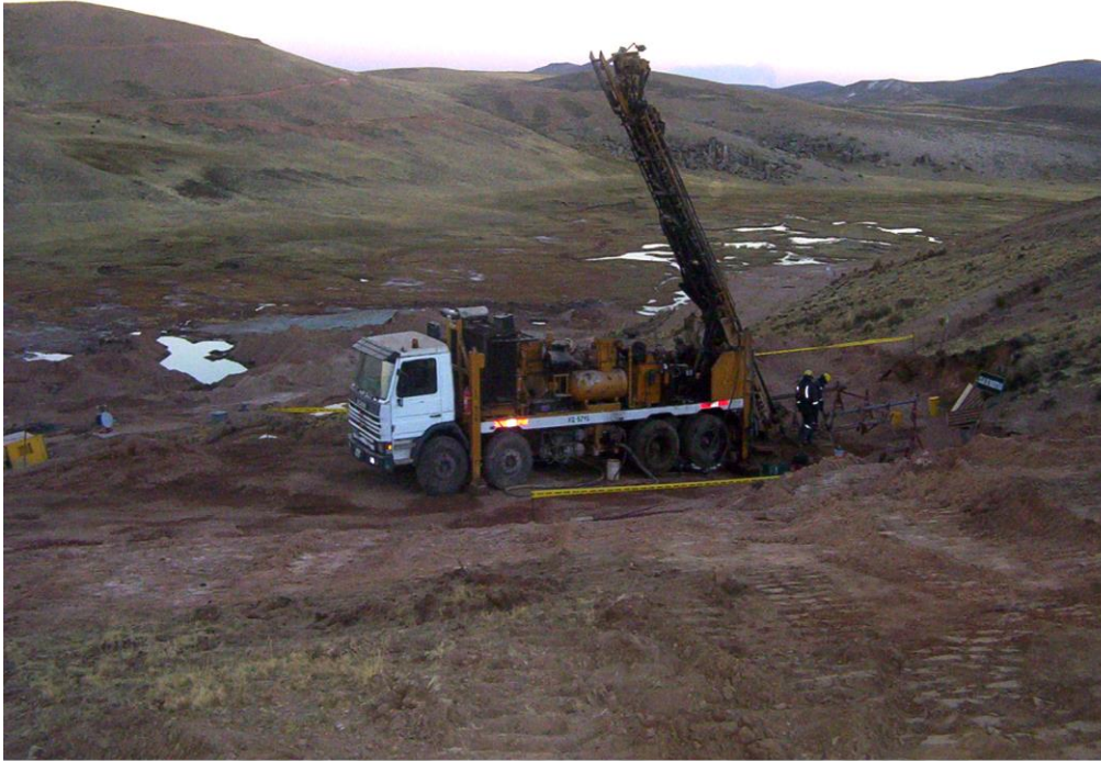
Figura 1. Equipo de perforación diamantina GEO 3000. Fuente: adaptación propia en base a la investigación realizada, 2022.
