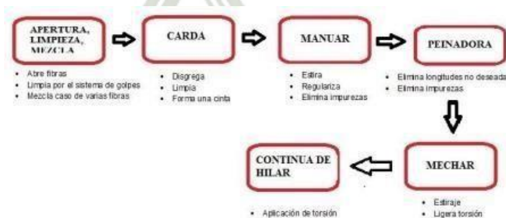
Figura 2. Proceso de hilatura para fibras cortas (Palomino, 2018).
