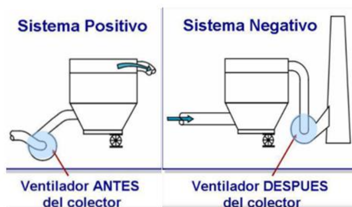
Figura 8. Localización del ventilador según las características del material.
