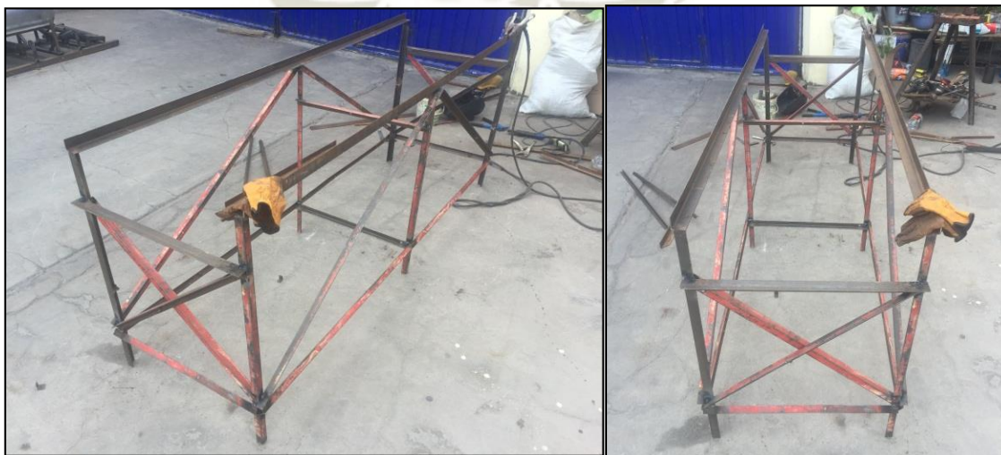
Figura 64. Estructura base del precipitador electrostático
