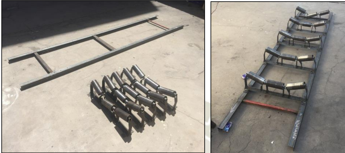
Figura 59. Estación de polines y bastidor
