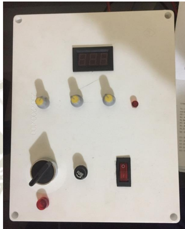
Figura 80. Cara exterior del tablero.
