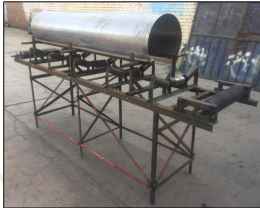
Figura 65. Ensamble de estructura base del precipitador electrostático
