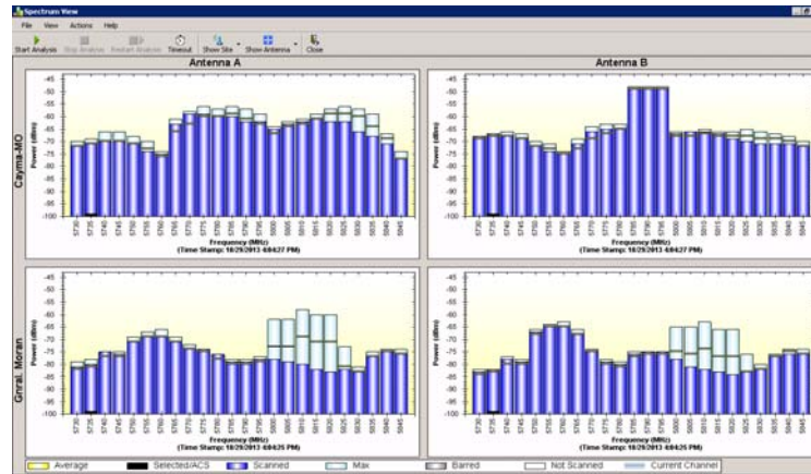
Figura [IV.6] Resultado de análisis de espectro con los transceiver en las sedes de Cayma y General Morán.
