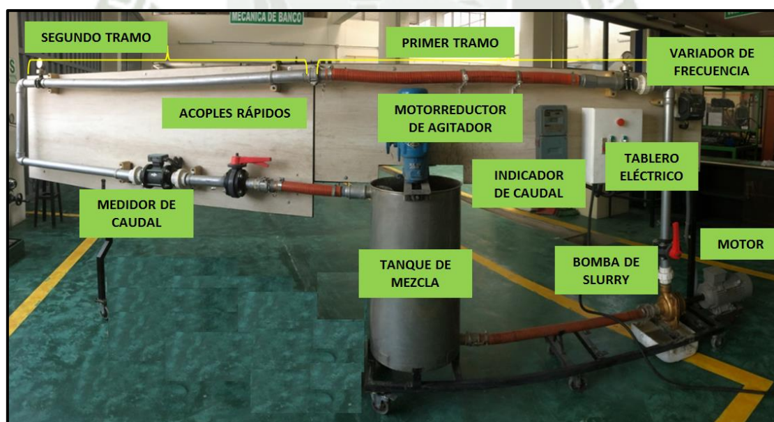
Figura 34. Partes Principales del módulo de bombeo de slurry.
