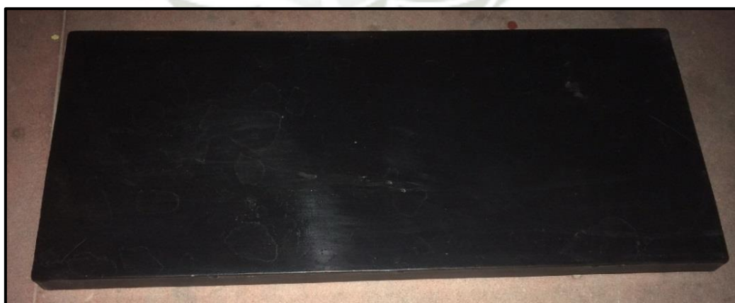
Figura 38. Placa rígida, para soporte de la bomba.
