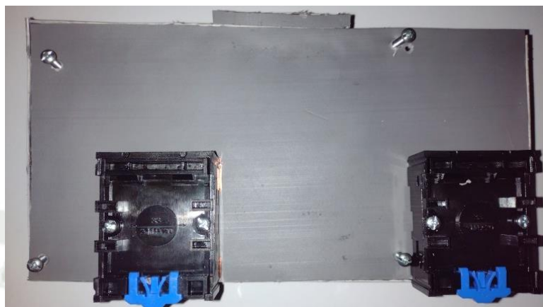
Figura 63 Carcasa del Controlador con los Adaptadores para Riel DIN ya Montados.
