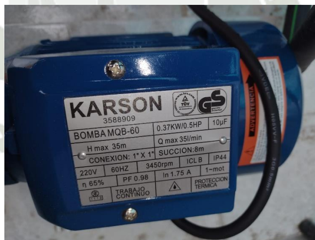
Figura 77 Bomba Eléctrica de 1/2 HP.
