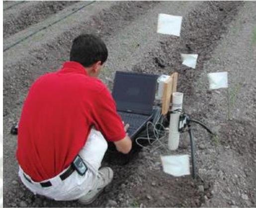
Figura 14 Medición de Humedad del Suelo con Tensiómetro.
