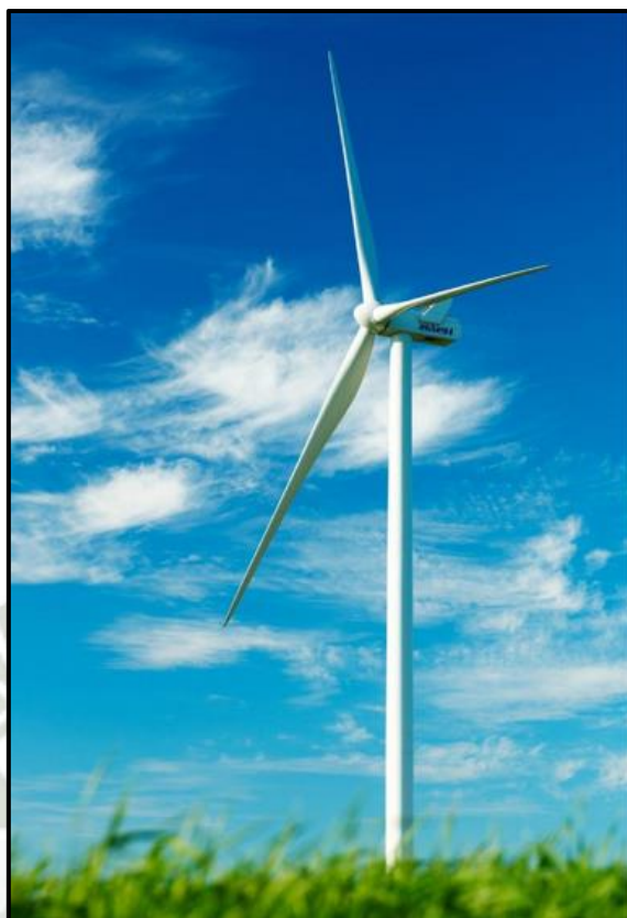
Figura 12. Turbina Eólica de eje horizontal. Potencia Nominal 3 MW, diámetro de rotor 112m, altura de la torre 119m. Fuente: Vestas (2013)
