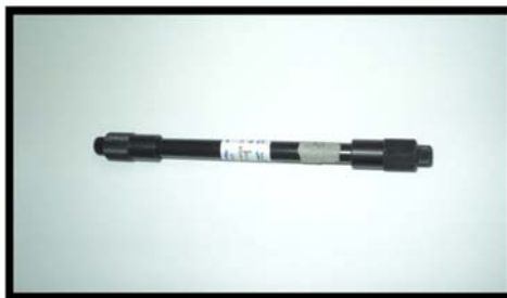
FIGURA N° 18: Columna monolítica empleada en el ensayo.
