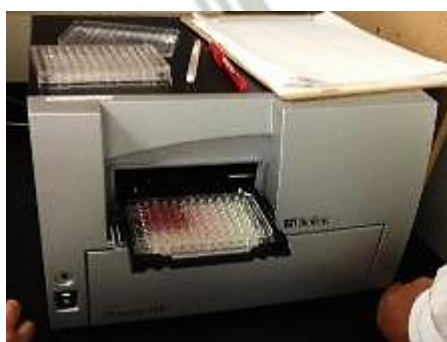
Fig. 6 Ensayo de viabilidad celular, utilizando el equipo Synergy HT (Lector multimodal de microplacas).
