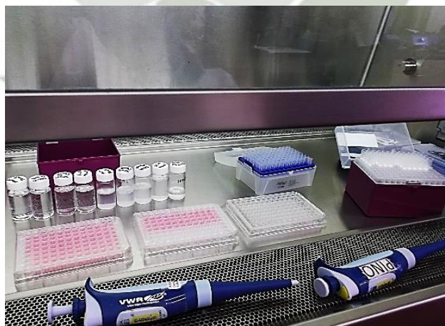
Fig. 5 Cabina de bioseguridad clase II tipo A2, donde se realizaron los ensayos experimentales.
