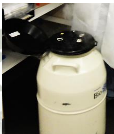
Fig. 2 Tanque criogénico de nitrógeno líquido en fase de vapor. Fuente: elaboración propia.
