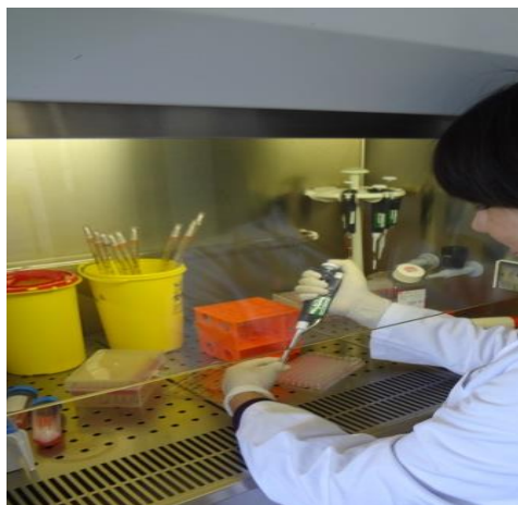
Fig. 12 Cabina de Bioseguridad clase II tipo A2, donde se realizaron los ensayos experimentales con el Coxsackievirus B4. Fuente: Elaboración propia.
