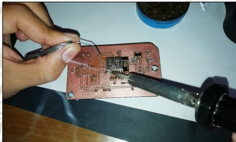
Figura 4.23 Soldadura de componentes a la placa Fuente: Propia
