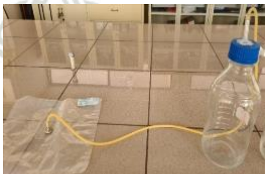
Figura 2 Diseño experimental del sistema armado para la evaluación óptima de biogás
