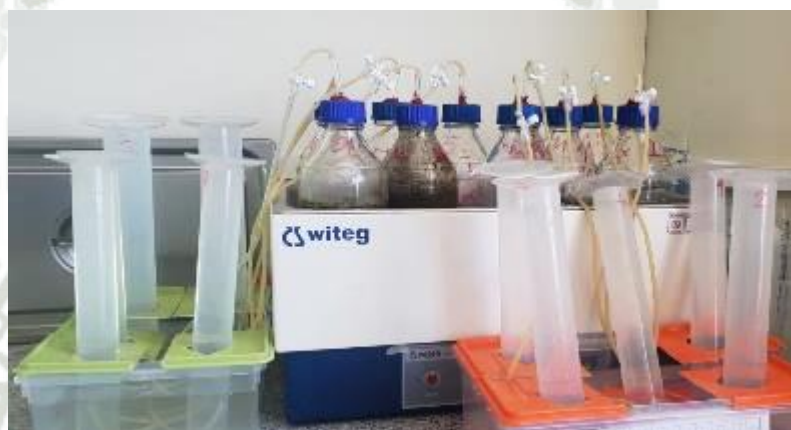
Figura 4. Sistema de probetas invertidas para evaluar capacidad volumétrica *fotografía de referencia
