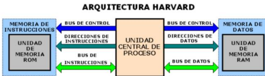
Fig. 9: Diagrama de bloques de la arquitectura Harvard
