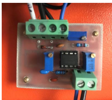
Fig. 43: Circuito de acondicionamiento del transmisor de temperatura
