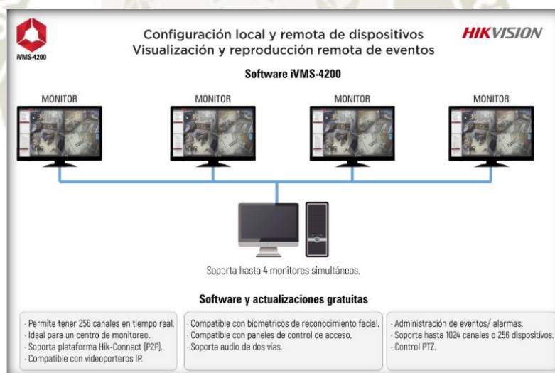
Figura 45: Diagrama de componentes del Software IVMS 4200 Fuente. Manual de usuario Hikvision - IVMS-4200. (2015).
