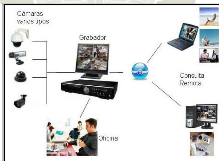
Figura 12: Sistema CCTV Fuente: Techtrol (2016)
