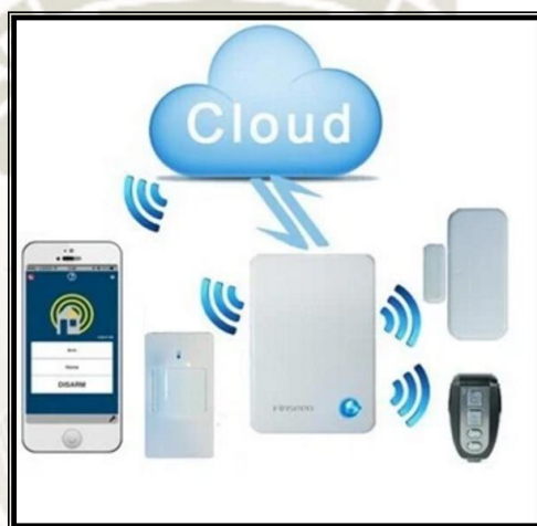
Figura 26: Alarma IP con Servidor Cloud Fuente: Made in china (2013)
