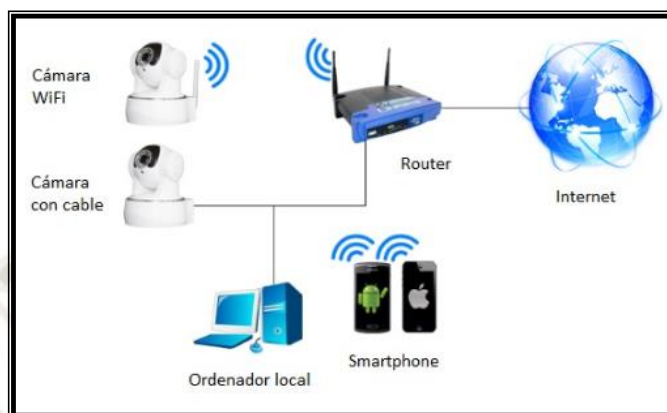
Figura 22: Ejemplo de conexión de los Puntos WIFI Fuente: García, F. (2010)
