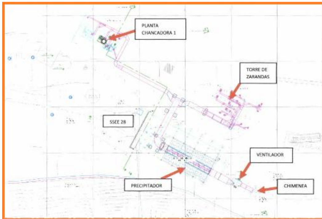
Figura N° 3. 10: Vista de Planta de Ductos Colectores.
