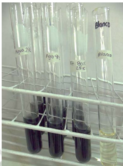
Figura N° 11 Determinación de la presencia de taninos mediante prueba de cloruro férrico.
