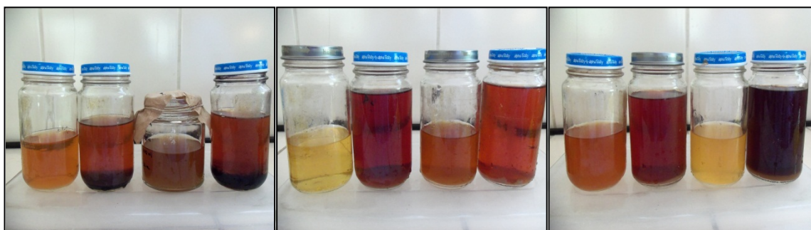
Figura N° 8 Extractos líquidos de las 12 muestras obtenidas de las vainas de Tara.
