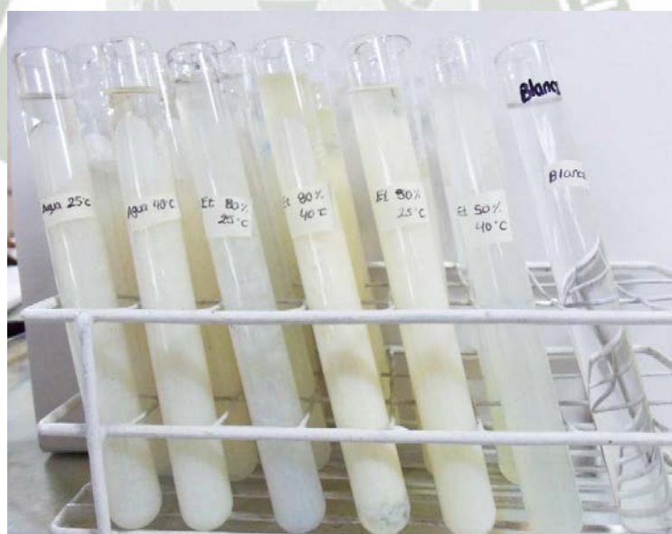
Figura N° 12 Determinación de la presencia de taninos mediante prueba de Acetato de plomo.
