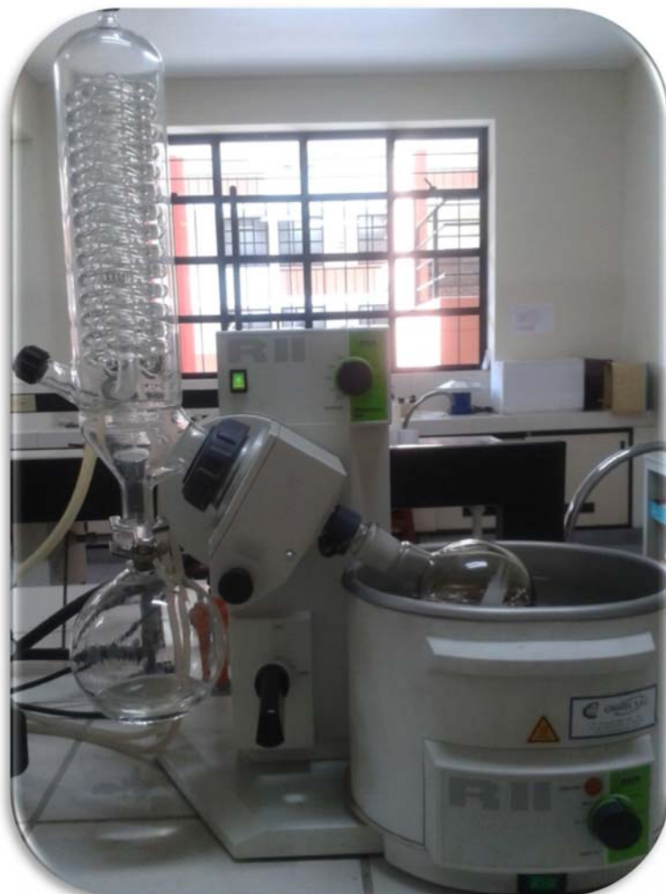
Figura: N° 22: Evaporación del extracto de Rivina Humilis L. por medio del Rotavapor
