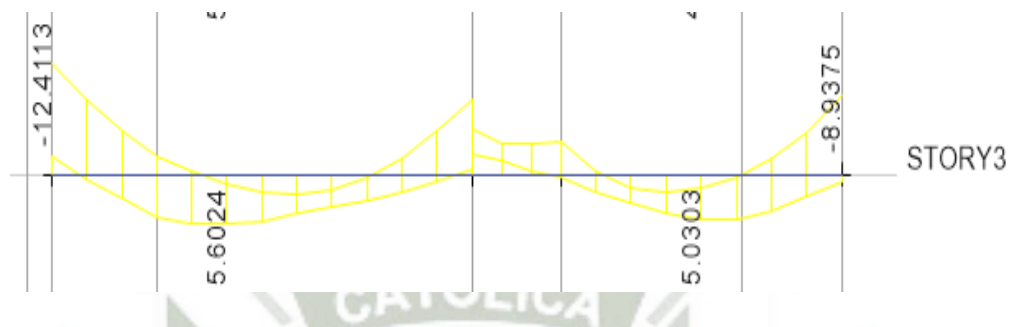
Figura 6.23 Envolvente Diagrama de Momentos Flectores en Viga del Eje F, Piso 3.
