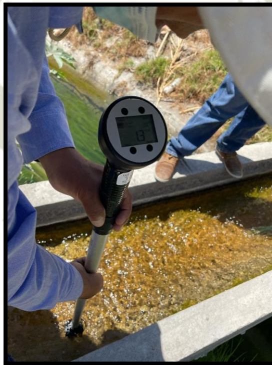
Fotografía 12: Aforo del canal 2 Mococho
