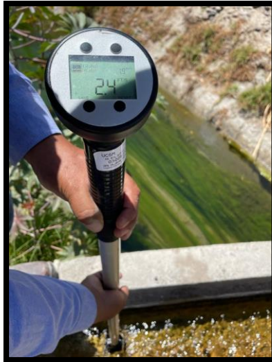
Fotografía 01: Aforos de aguas de retorno con correntómetro.
