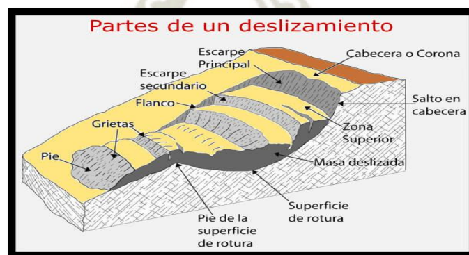
Ilustración 01: Partes de un deslizamiento
