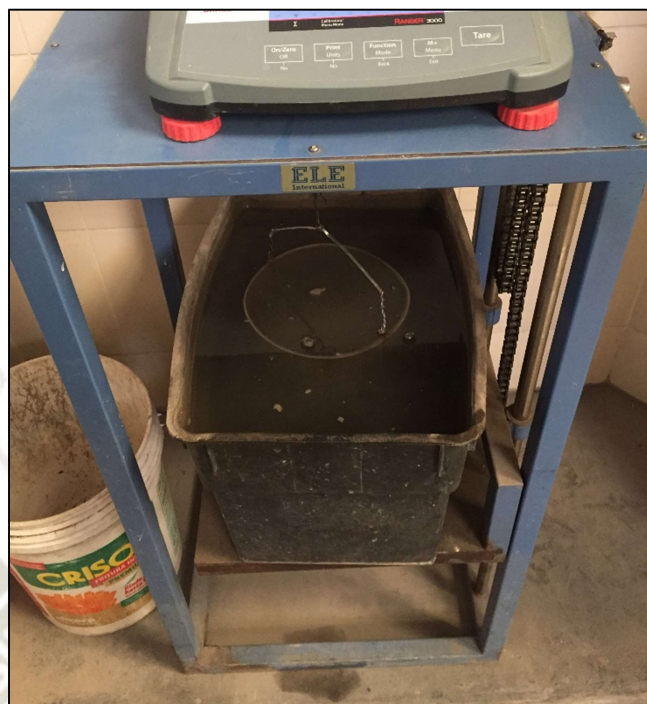
Imagen: 5 Ensayo porcentaje de absorción Agregado Grueso
