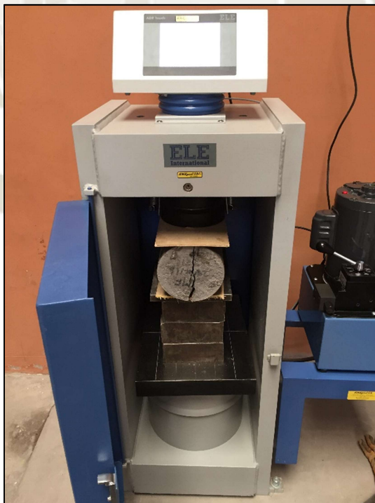
Imagen: 12 Ensayo de Resistencia a Tracción
