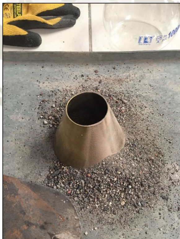
Imagen: 6: Ensayo Peso específico Agregado Fino
