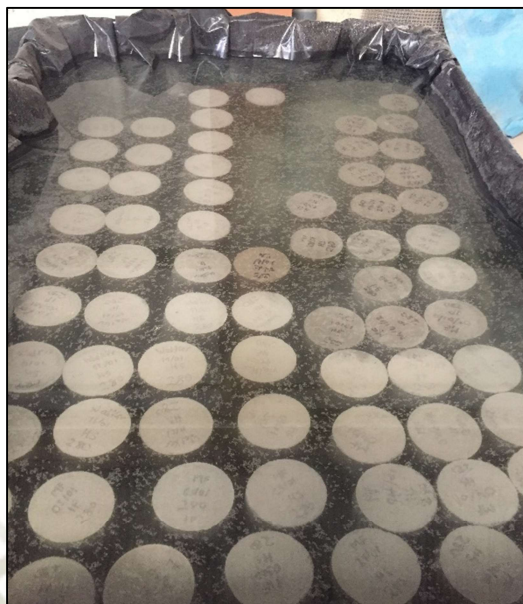
Imagen: 9 Proceso de Curado de probetas.
