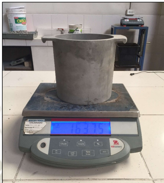
Imagen: 3 Ensayo Peso Unitario Suelo Agregado fino.
