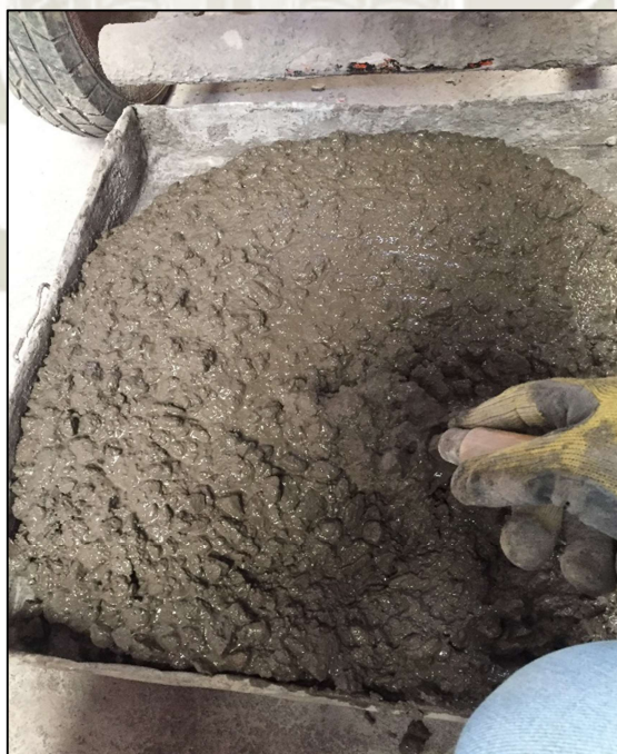
Imagen: 8 Mezcla en estado Plástico para diseño optimo
