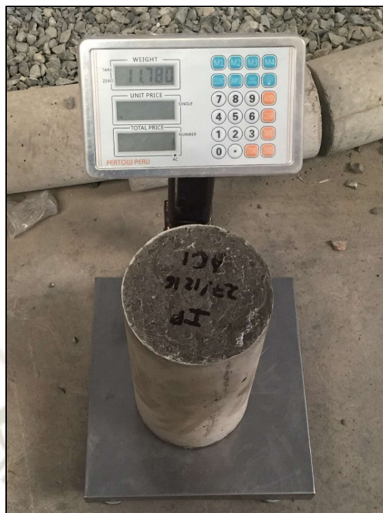
Imagen: 13 Ensayo de Peso Unitario de Concreto
