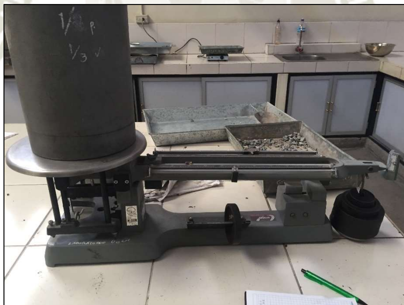
Imagen: 4 Ensayo de Peso unitario compactado Agregado grueso
