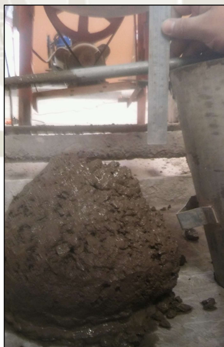
Imagen: 14 Ensayo de Cono de Abrams
