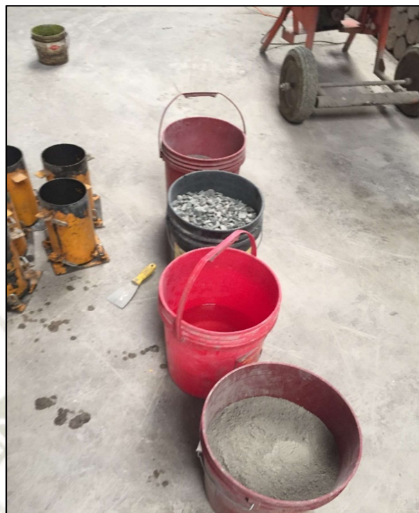
Imagen: 7 Preparación de materiales para Mezcla
