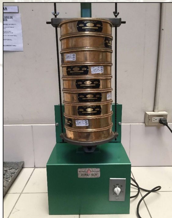
Imagen: 2 Tamizado de Agregado Fino.
