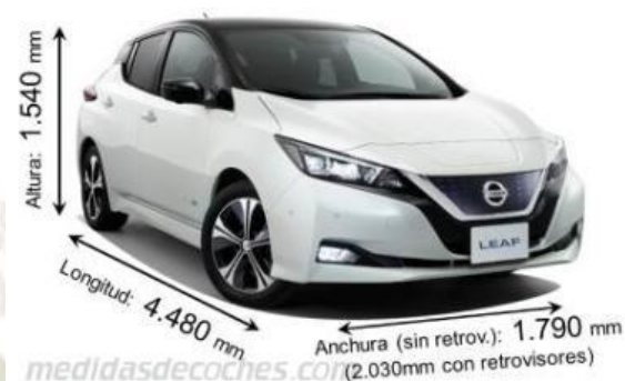
Figura 50 dimensiones del vehículo
