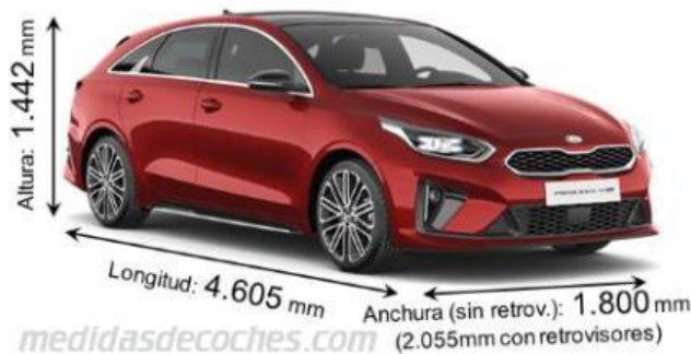
Figura 48 dimensiones del vehículo
