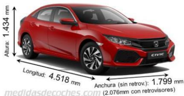
Figura 56 dimensiones del vehículo
