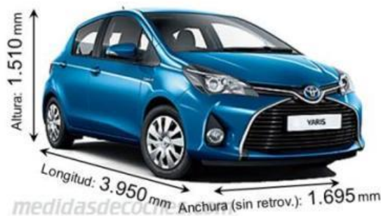
Figura 49 dimensiones del vehículo
