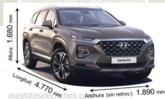
Figura 61 dimensiones del vehículo
