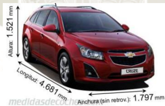
Figura 55 dimensiones del vehículo
