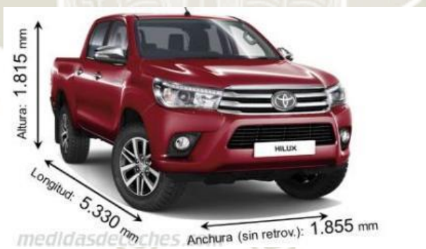
Figura 57 dimensiones del vehículo
