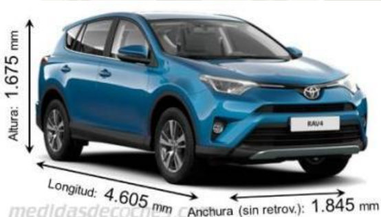
Figura 59 dimensiones del vehículo
