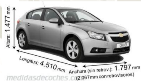
Figura 51 dimensiones del vehículo
