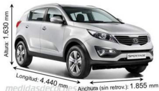
Figura 58 dimensiones del vehículo
