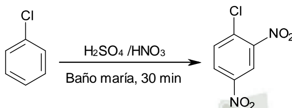
Fig.4 – Reacción de formación del 2,4 Dinitrocloro Benceno
