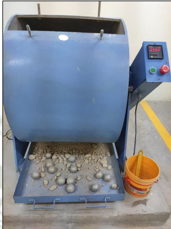
Imagen 11 Ensayo de abrasión de los ángeles
