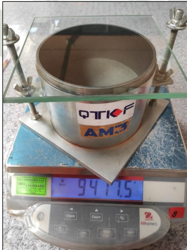
Imagen 16 Determinación del volumen del molde de 6" por el método de llenado de agua
