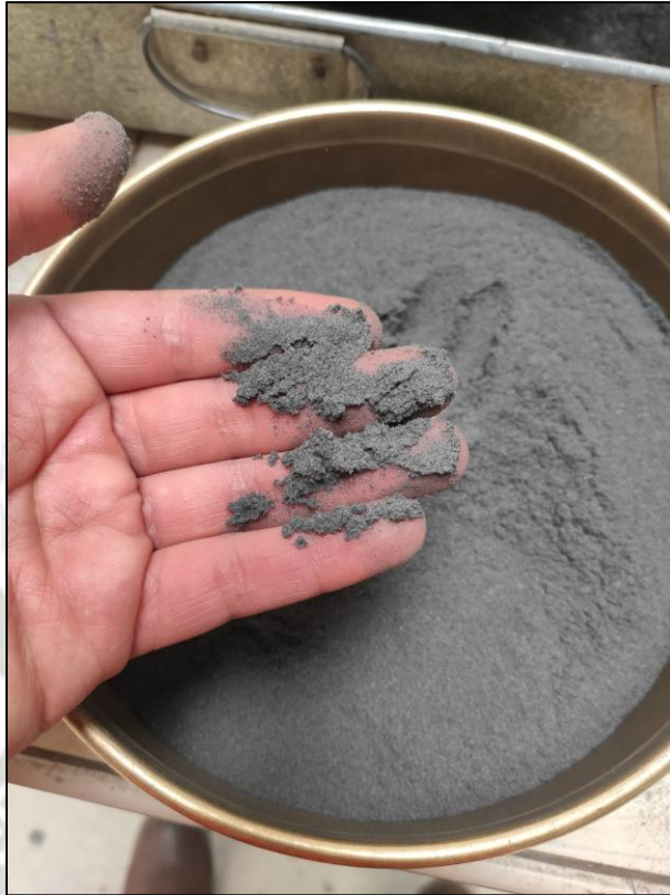
Imagen 25 Tamizado de la ceniza para ensayar (tamiz n°60)
