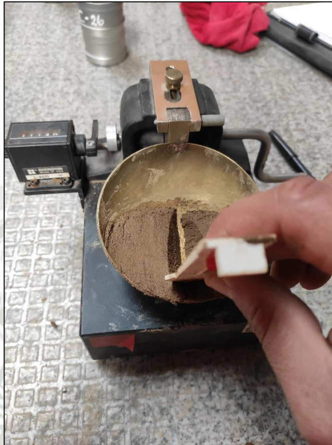
Imagen 9 Ensayo de limite liquido
