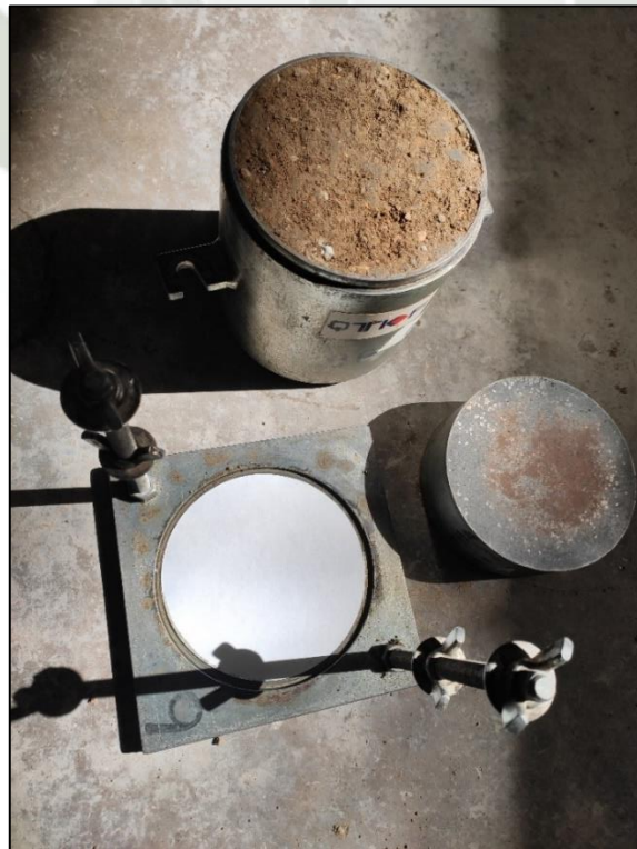
Imagen 18 Ensayo de cbr - afirmado
