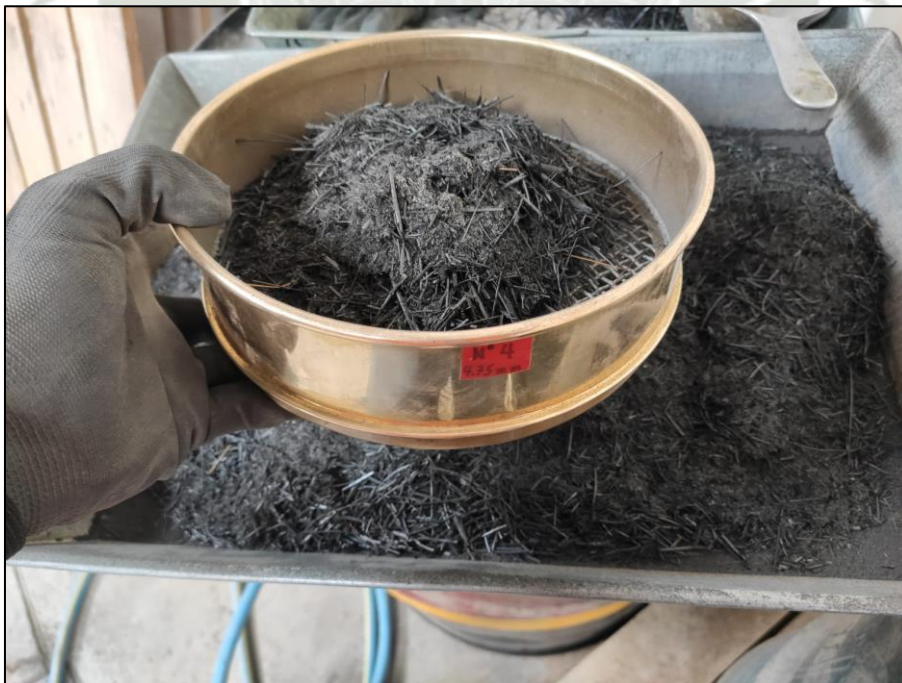
Imagen 26 Tamizado de la ceniza para ensayar (tamiz n°04)
