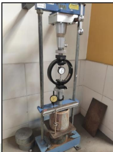
Figura 19 Ensayo de Penetración de CBR
