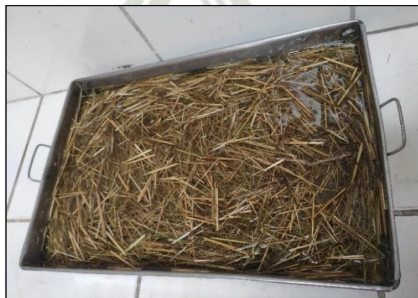
Figura 22 Saturación de la Fibra de Ichu
