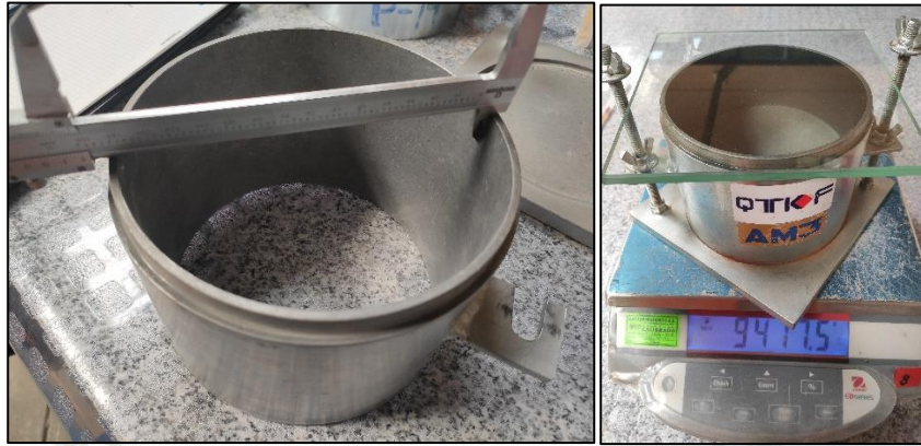
Figura 15 Cálculo del volumen del molde 6"
