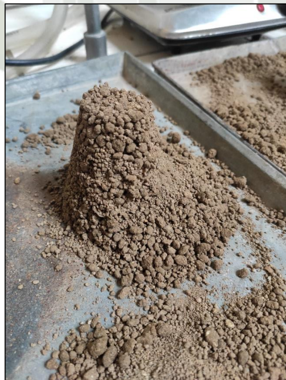
Imagen 12 Ensayo de gravedad específica del agregado fino
