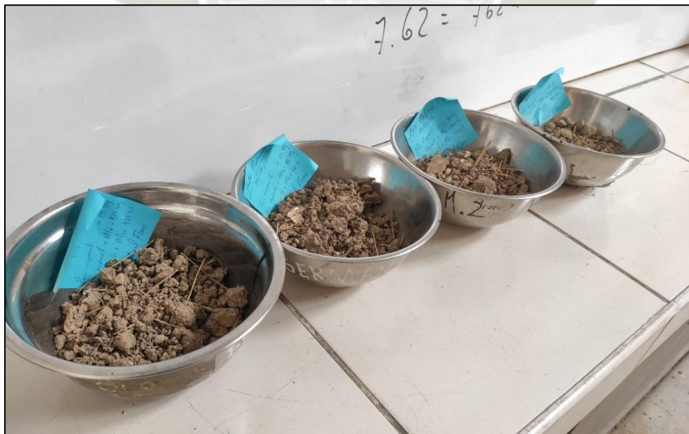
Imagen 24 Obtención de muestras para hallar el %contenido de humedad
