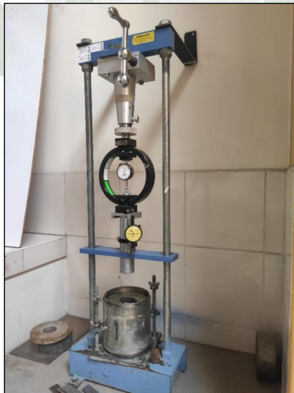
Imagen 28 Ensayo de Penetración del molde para obtener el %CBR
