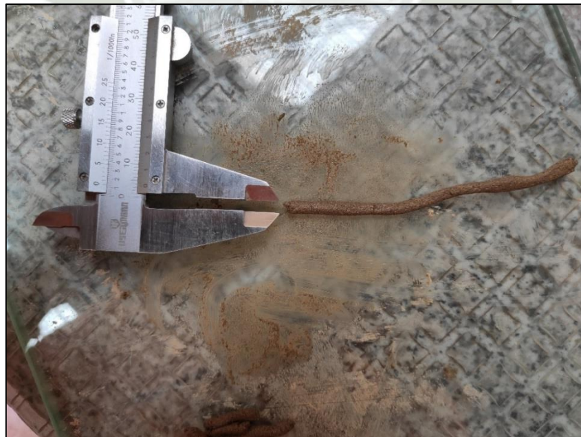
Imagen 10 Ensayo de limite plástico
