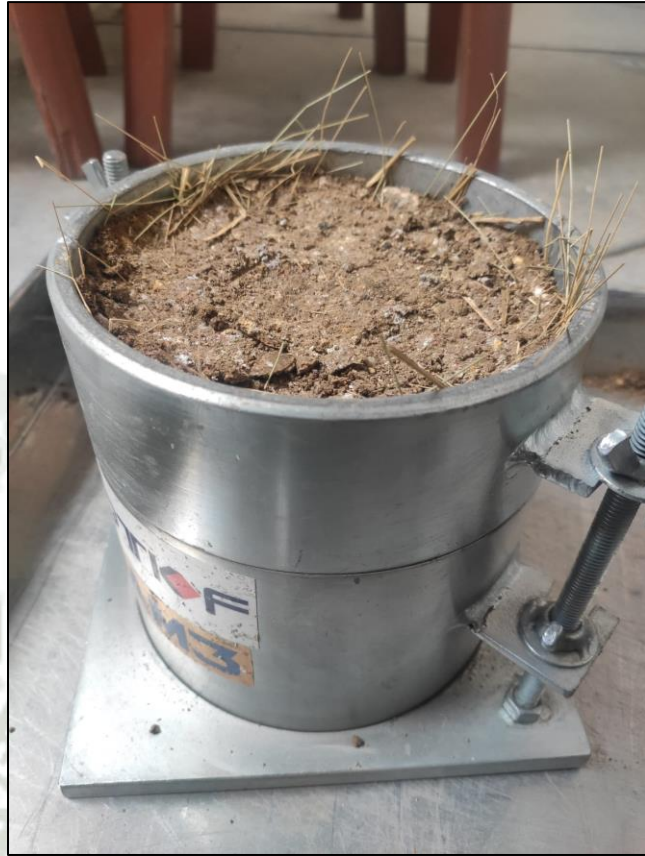
Imagen 23 Muestra de %fibra de ichu + afirmado en molde de proctor modificado de 6"
