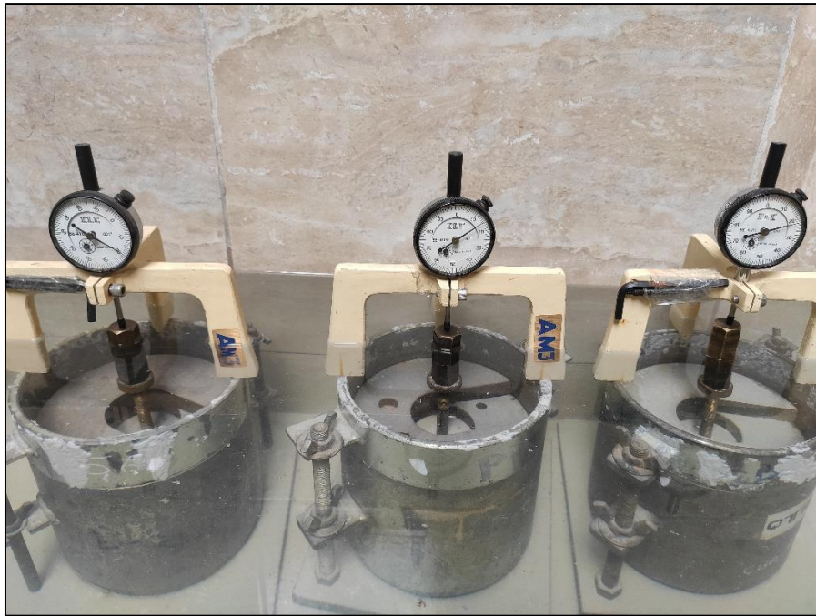
Imagen 19 Inmersión de muestras en tanque de agua
