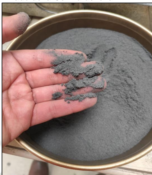
Figura 25 Tamizado de la Ceniza de ichu
