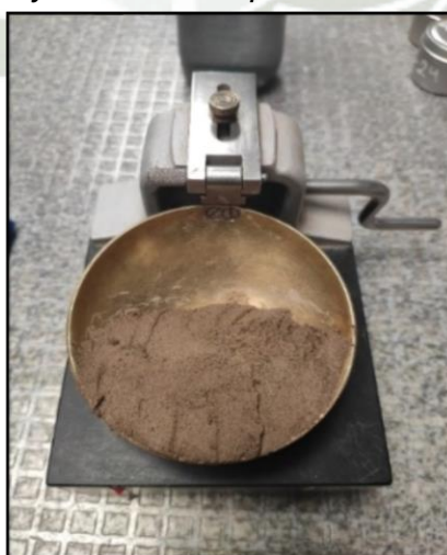
Figura 13 Ensayo de Limite Liquido
