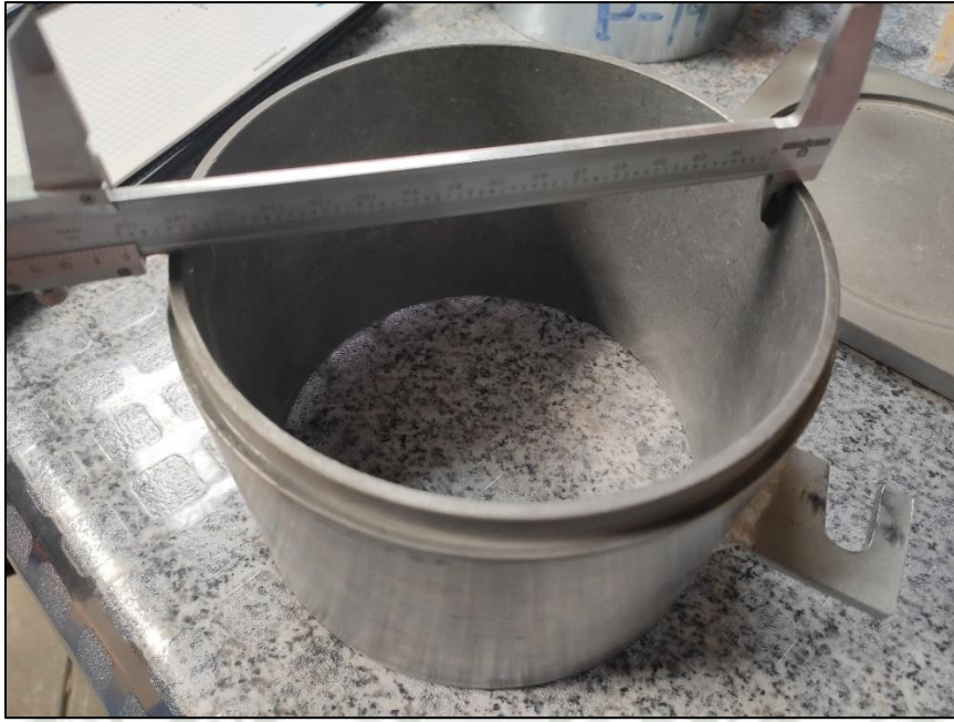
Imagen 15 Determinación del volumen del molde de 6" por el método de medición lineal
