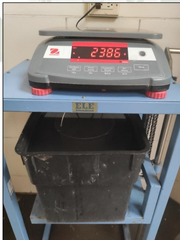
Imagen 14 Ensayo de gravedad especifica del agregado grueso
