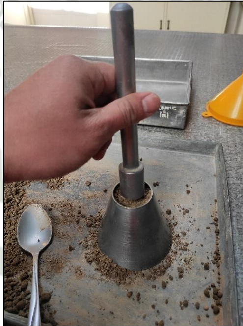
Figura 7 Ensayo de Gravedad específica del ag. fino
