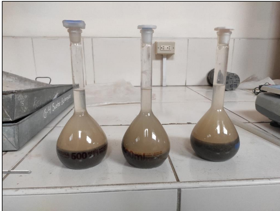
Imagen 13 Ensayo de gravedad especifica del agregado fino
