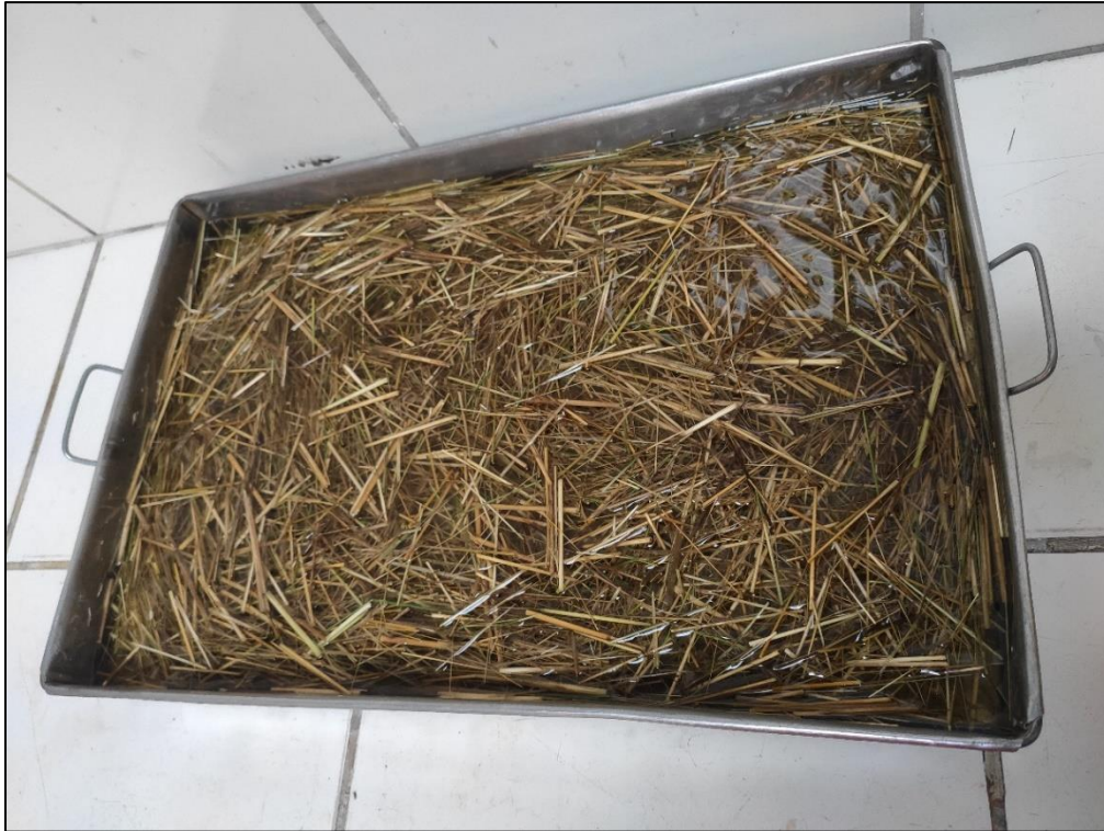
Imagen 21 Saturación de la fibra de ichu para ensayo de Proctor modificado
