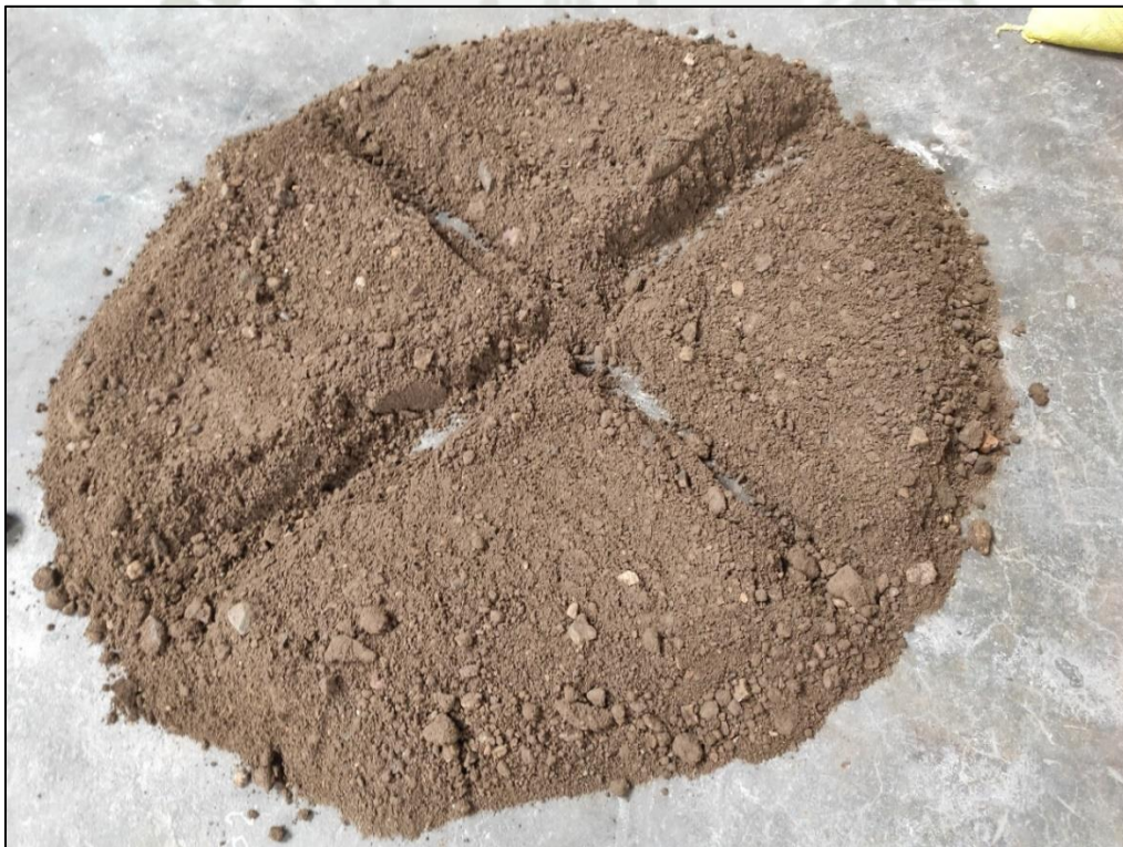
Imagen 6 Cuarteo de muestra para ensayar
