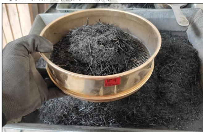
Figura 32 Ceniza tamizada en malla N°4
