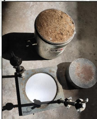
Figura 17 Ensayo de CBR
