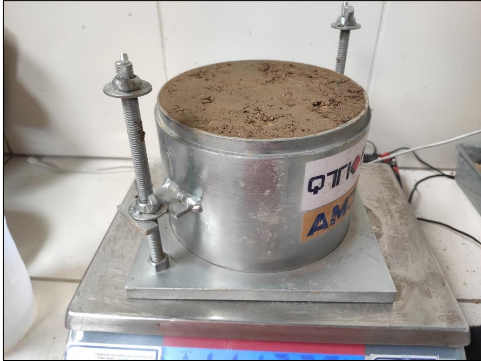
Imagen 17 Ensayo de Proctor modificado para cbr
