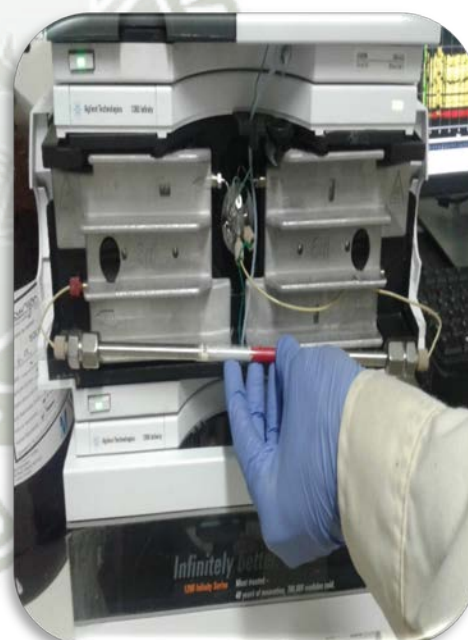
Fotografía N° 12. Columna Luna Phenyl Hexyl 250 mm X 4.0 mm (5 \mu m).
