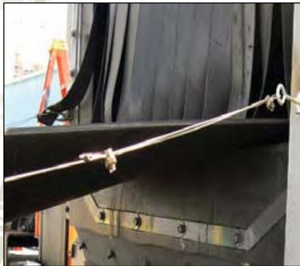
Figura 8. Control pasivo de polvo el uso de cortinas de caucho.
