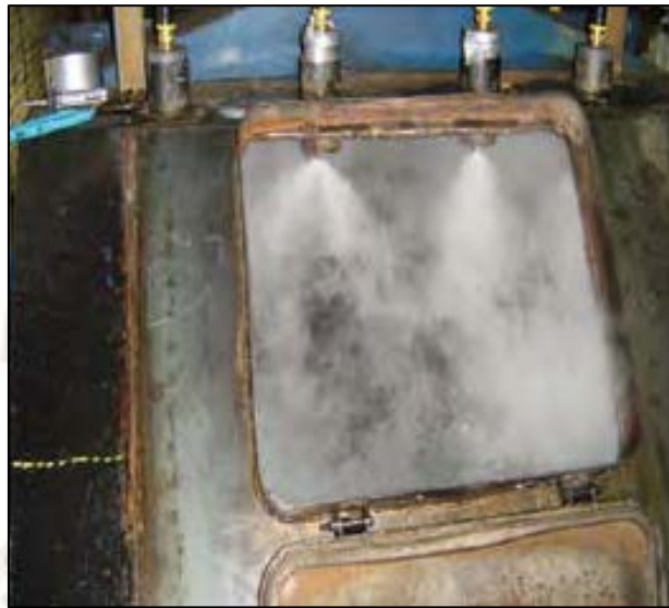
Figura 11. Control activo de polvo mediante la supresión con niebla.
