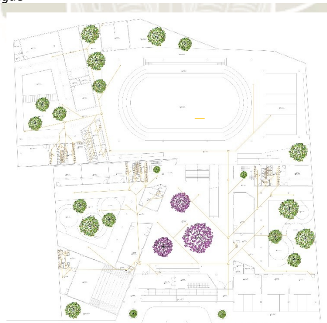
Red de desagüe
