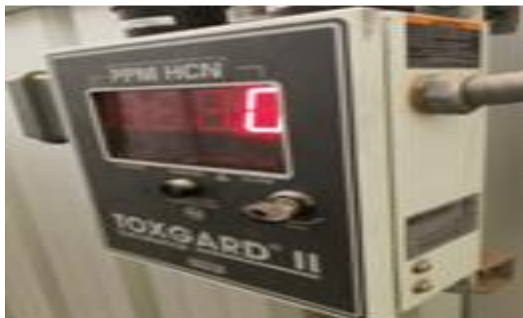
Figura 47 Equipo detector de gases de cianuro con energía
