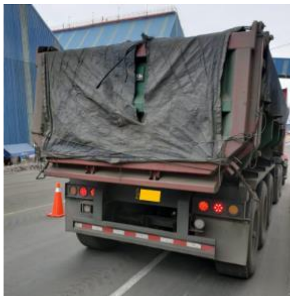
Figura 36 Toldo dañado de camión tercero
