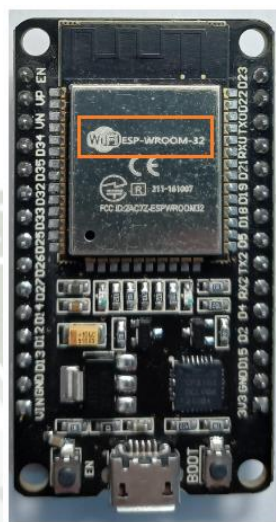
Figura 29: Tarjeta de desarrollo ESP32 DEVKIT V1.
