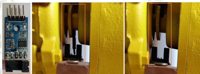
Figura 24: Sensor de AR-FC03 montado en el motor.
