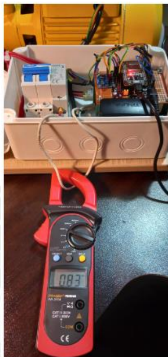
Figura 128: Comprobación de corriente.
