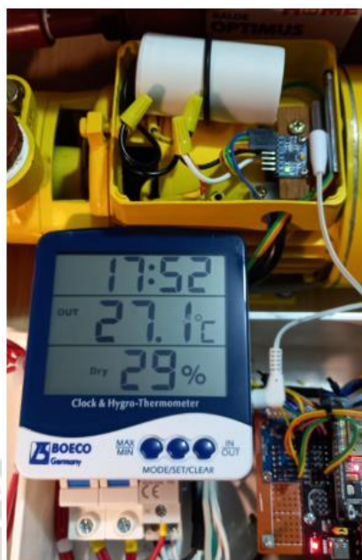
Figura 130: Comprobación de temperatura.
