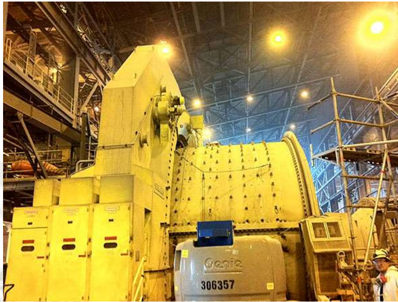
Figura N° 34 Molino Gearless de gran potencia
