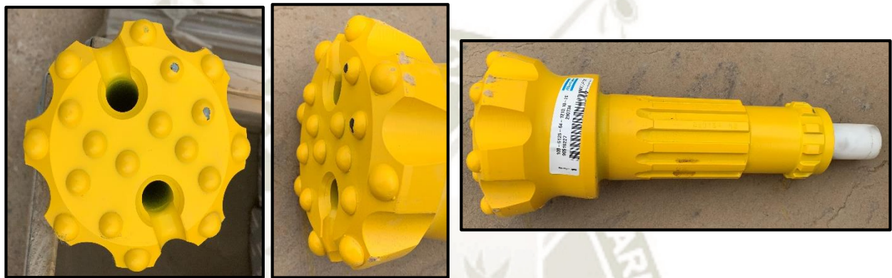
Ilustración 3: Broca DHT con insertos esféricos.
