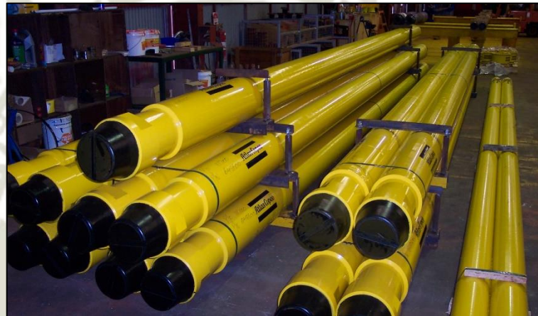
Ilustración 8: Barras de perforación Rotary.
