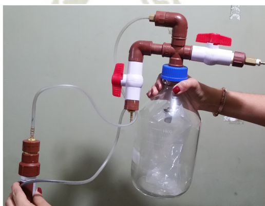
Figura 2.1: Sistema Diseñado para el almacenaje temporal de un volumen conocido de Biogás que transitará por los filtros piloto. Agradecimiento a Ing. Oscar Medina de Biotcorp
