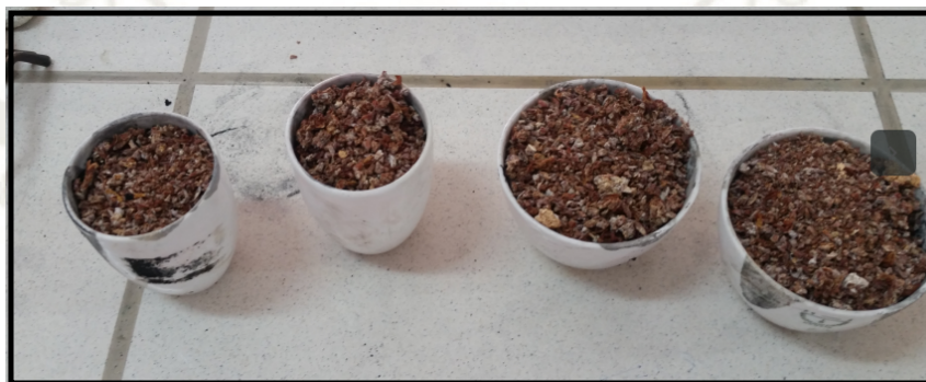
Figura D.1: Material 01, Cascarilla de Arroz activada con KOH, lavada y secada, en este punto ya desarrolló un poco la porosidad
