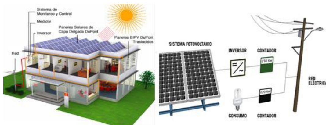
Figura 1. Sistema Fotovoltaico Conectado a Red.
