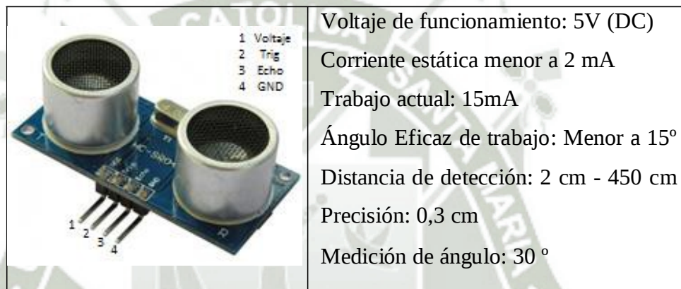
Figura 24. Especificaciones técnicas del sensor Ultrasónico HC-SR04.
