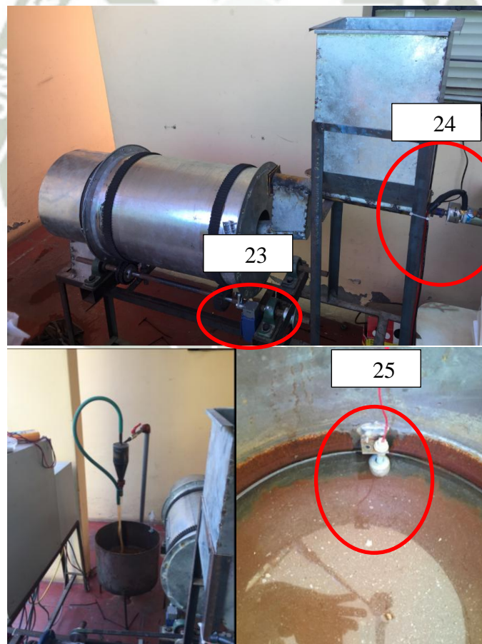
Figura 5.1.4. Instrumentos de campo y motor de alimentación de mineral. Fuente: Propia
