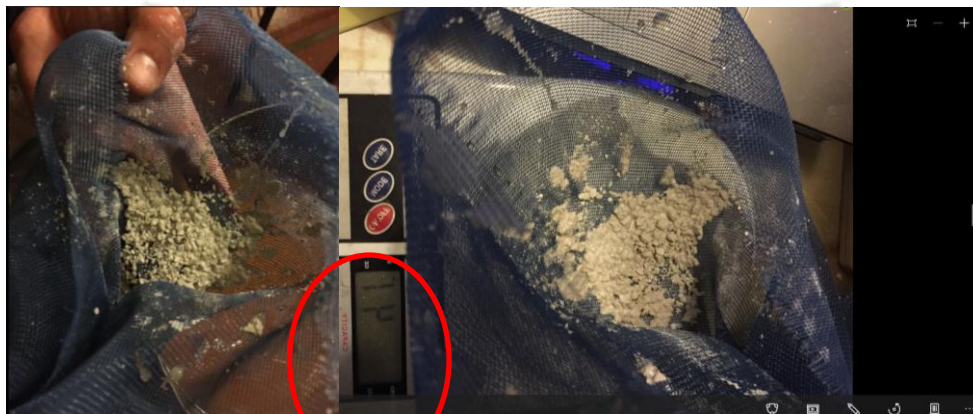
Figura 6.1.6.9: Peso de yeso producto de hidrociclón underflow. Fuente: Propia
