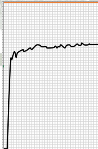
Figura 6.1.3.4.3. Respuesta transitoria a función escalón en zona 4 escalada. Fuente: Propia.
