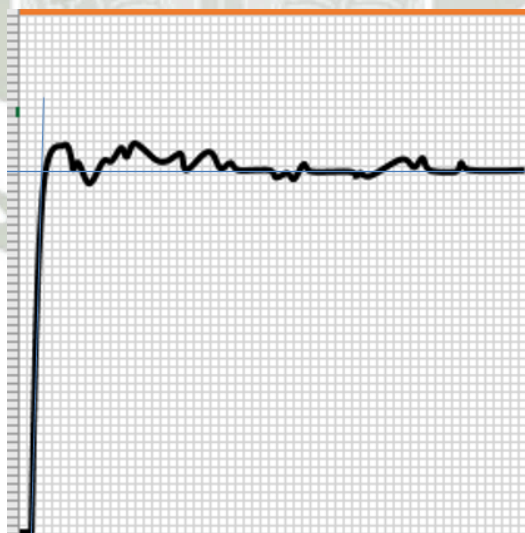
Figura 6.1.3.3.4. Líneas tangente y de régimen estable sobre respuesta de sistema en zona 3. Fuente: Propia.
