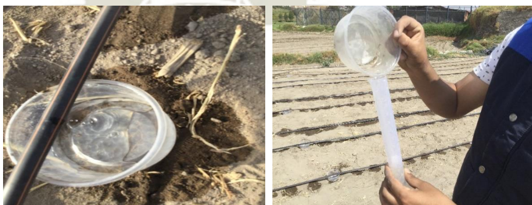
FOTOGRAFÍA 06 Medición de caudal del gotero con probeta
