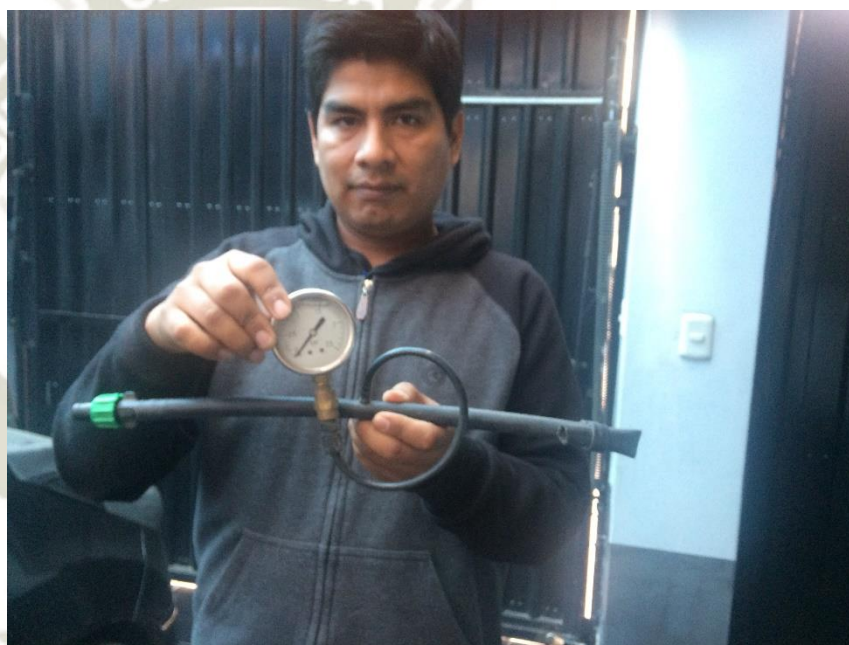
FOTOGRAFÍA 07. Medición de la presión en el gotero con manómetro
