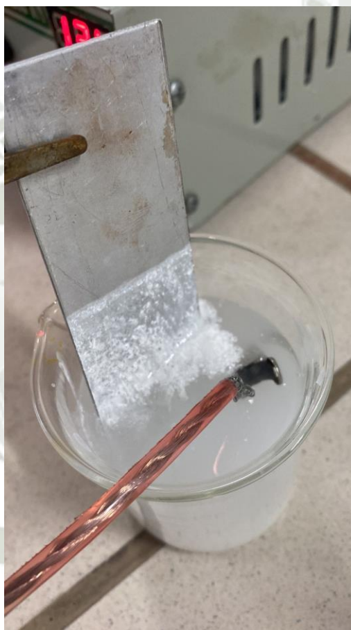
Figura 14: Aleación de aluminio con dióxido de titanio
