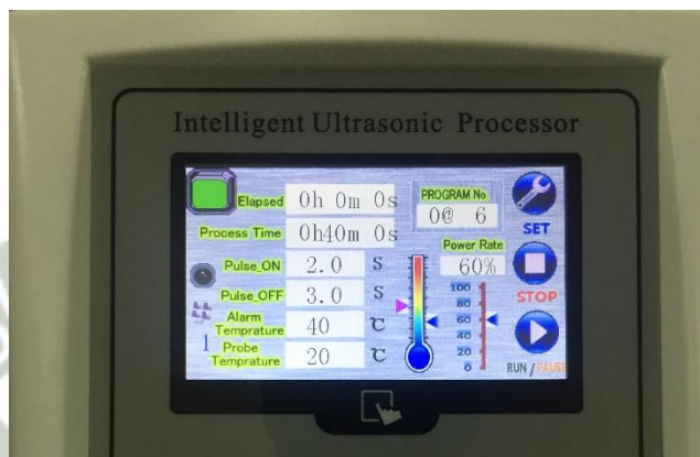
Figura 21. Parámetros del equipo de ultrasonido para la síntesis de nanofluidos.
