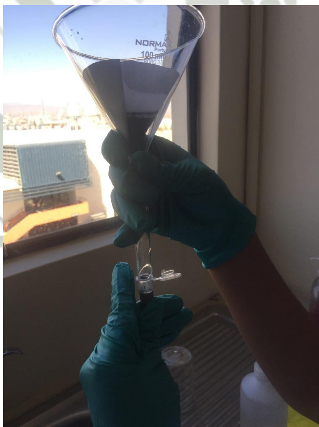
Figura 54. Proceso de filtrado para preparación de muestras para la caracterización en el Zetasizer. Fuente: Propia.
