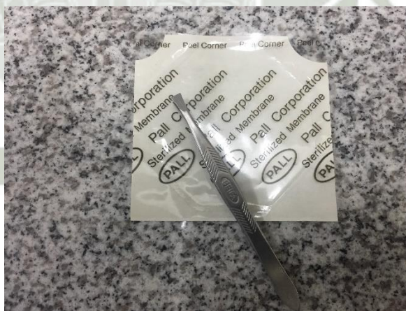
Figura 31. Membrana de 0.45\mu\text{m} de diámetro de poro. Fuente: Propia.
