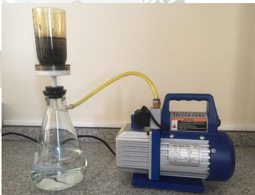
Figura 33. Esquema del sistema de filtrado. Fuente: Propia.
