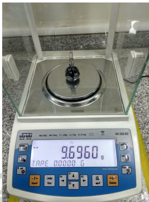
Figura 17. Peso del picnómetro con nanotubos de carbono. Fuente: Propia
