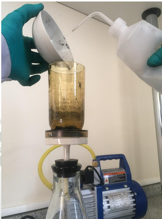
Figura 34. Proceso de lavado de los nanotubos de carbono. Fuente: Propia.
