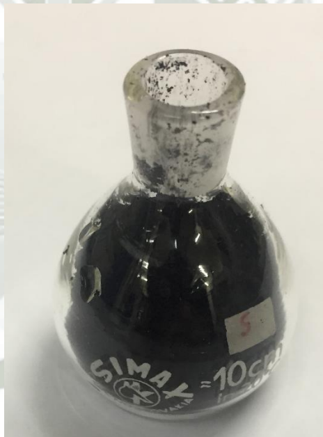
Figura 16. Picnómetro con nanotubos de carbono. Fuente: Propia
