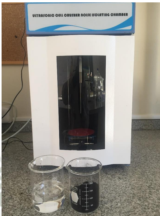
Figura 26. 3 gramos de NTC y 120 ml de ácido preparado para el tratamiento químico. Fuente: Propia.
