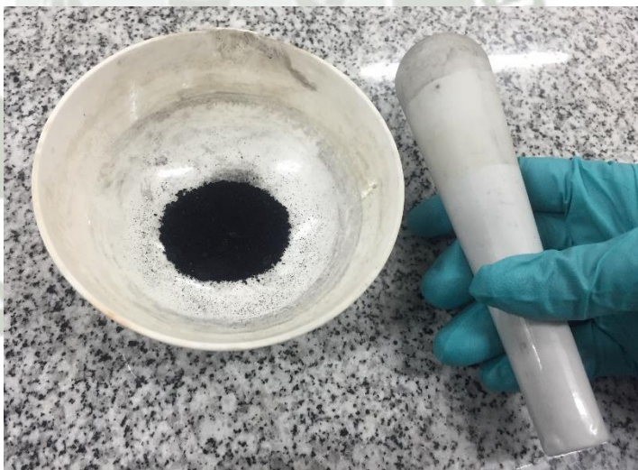
Figura 39. Mortero para el proceso de trituración de los nanotubos de carbono.
