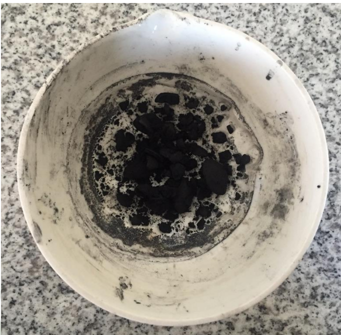
Figura 38. Nanotubos de carbono, después del secado a 100°C. Fuente: Propia.
